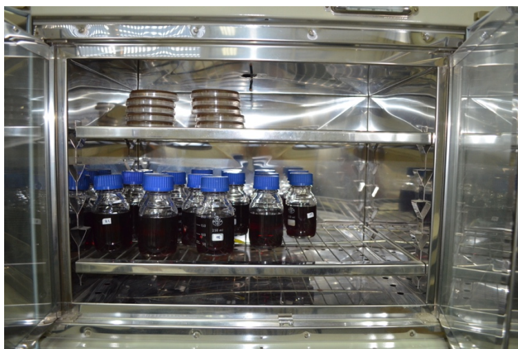
Figura 35: Análisis microbiológico. Disposición en estufa, 48 hs. a 37°C. Determinación de bacterias coliformes y Pseudomonas aeruginosa en 100 ml. Fuente: Elaboración propia.
