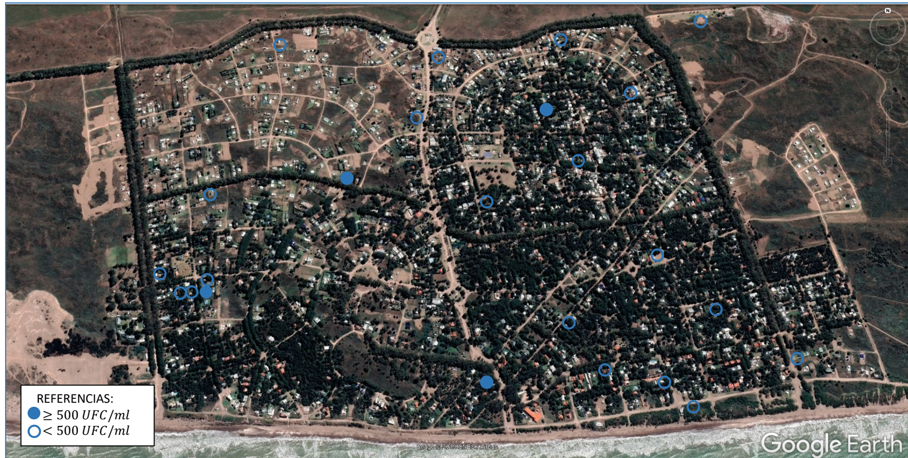
Figura 40: Resultados del Monitoreo de Heterótrofos en 100 ml. Diciembre 2019 Elaboración propia en base a imagen satelital de Google Earth
