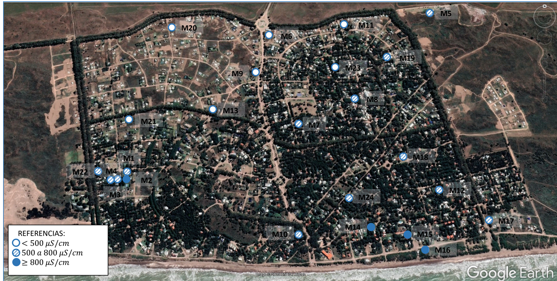
Figura 39: Resultados del Monitoreo de Conductividad. Diciembre 2019 Elaboración propia en base a imagen satelital de Google Earth
