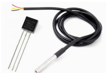
Fig. 14. TO-92 y su alternativa sumergible.
