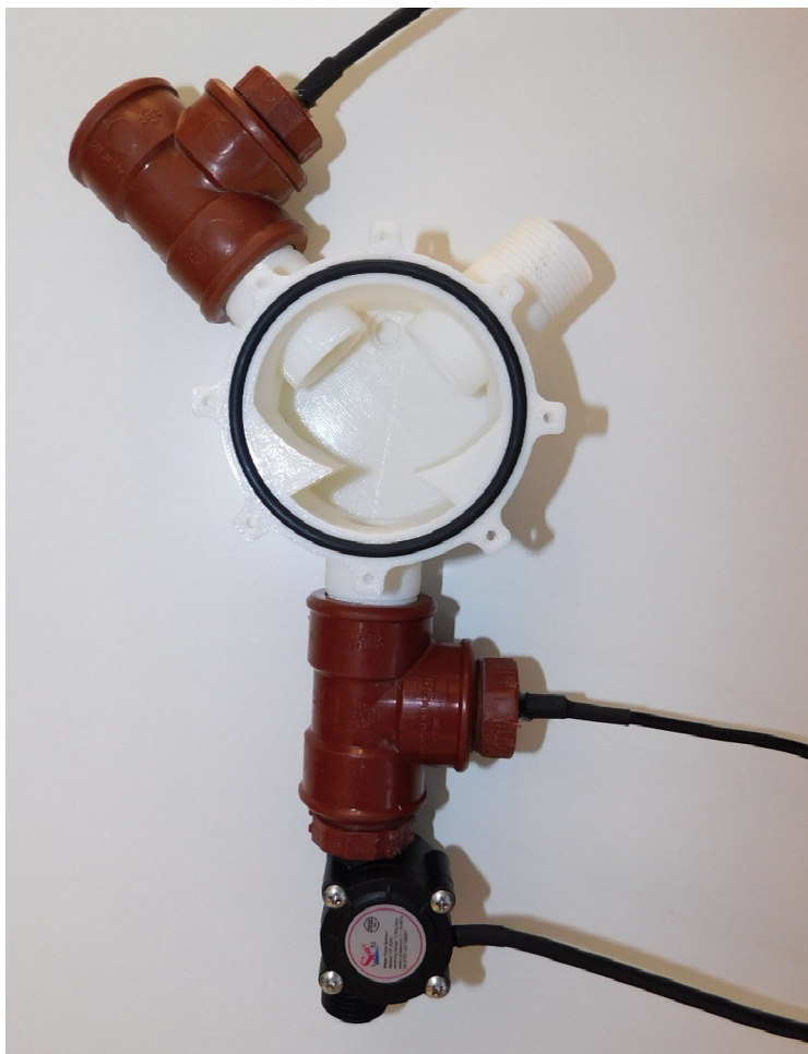
Fig. 50. Montaje de válvula y sensores
