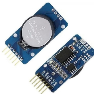
Fig. 19. Módulo RTC DS3231.
