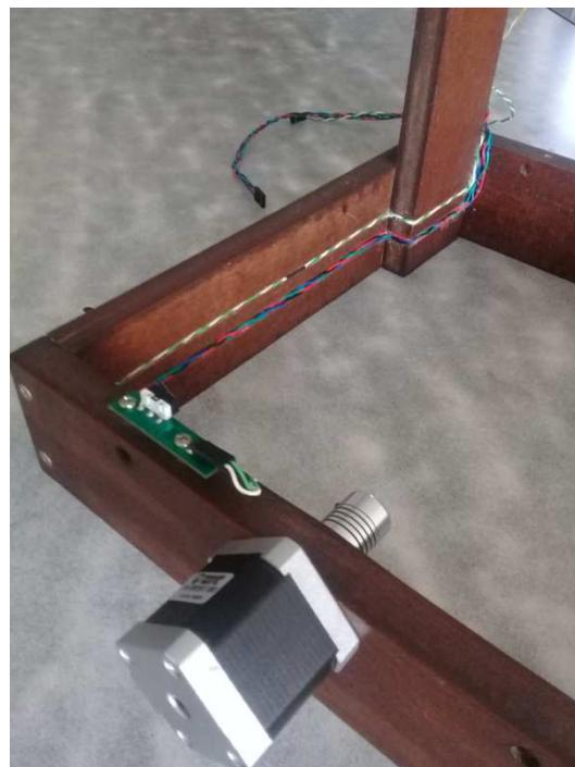
**FIG. N° 31** *Motor y estructura del eje X.*
