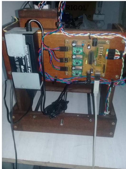
**FIG. N° 42** Parte posterior, donde se aprecia placa de control y la fuente de alimentación.
