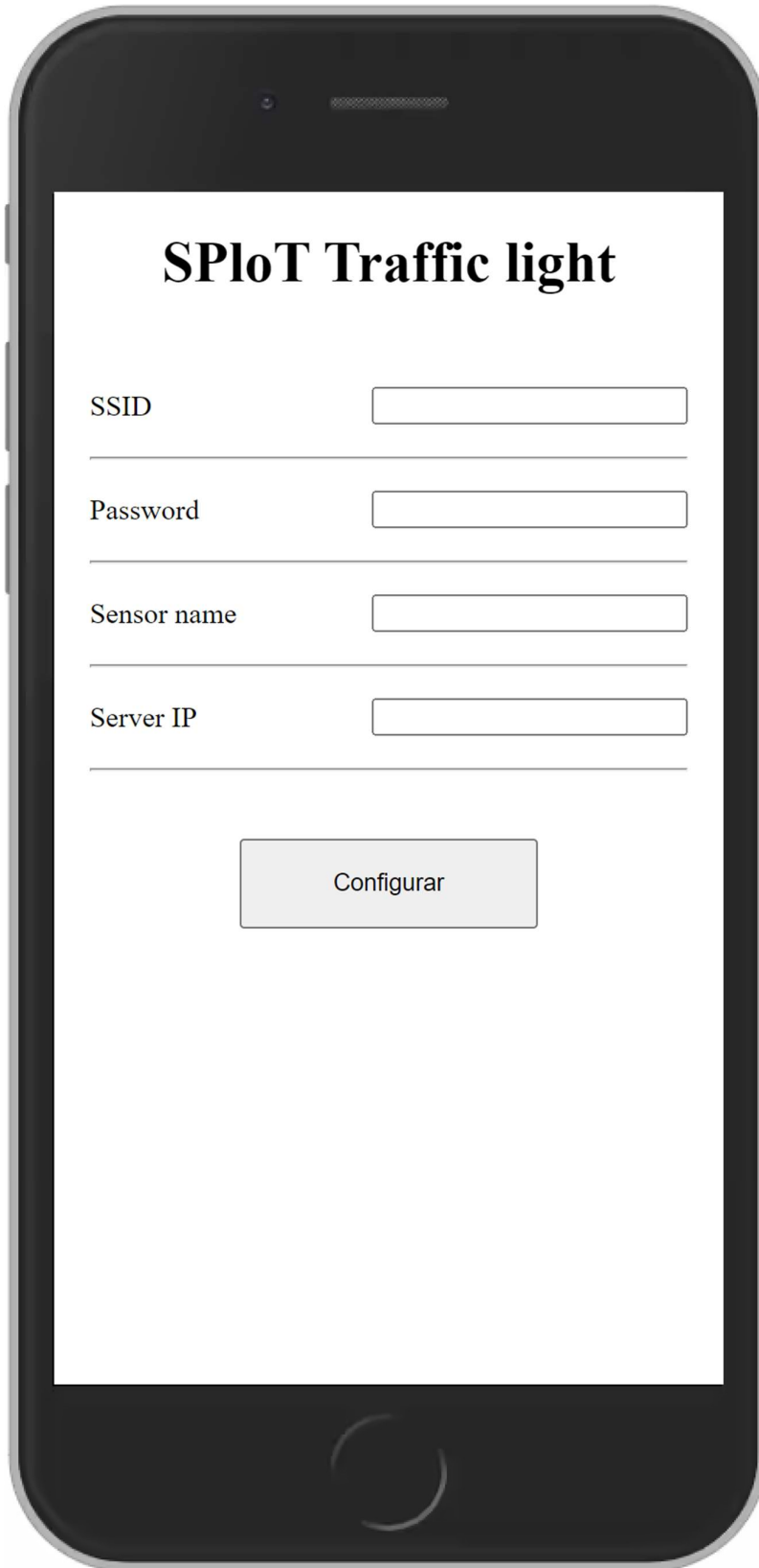
Figura 23: Web server del semáforo.
