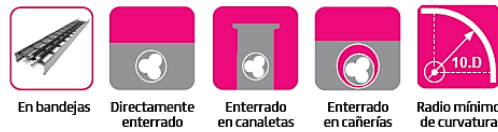
MC-MT Ilustración 6.1 - Características Retenax MT- Fuente: Prysmian
