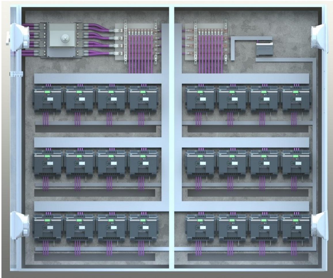
Ilustración 9.62 – Tablero variadores de velocidad -. Fuente: Propia
