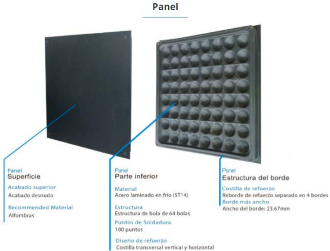
MC-BT Ilustración 4.4 - Conformación Paneles - Fuente: Interfloor
