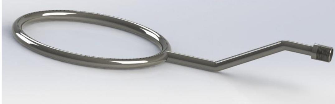
Fabricación: Se suelda en la entrada de aire un caño de 1/2 in roscado para la conexión con la válvula solenoide y este se suelda, de tal manera que, el aireador quede centrado a la envolvente CU-001-B.
