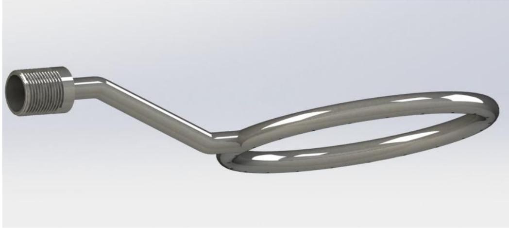
Fabricación: Se suelda en la entrada de aire un caño de 1/2 in roscado para la conexión con la válvula solenoide y este se suelda, de tal manera que, el aireador quede centrado a la envolvente CU-001-A.
