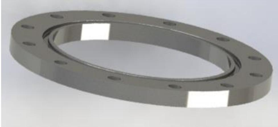
Fabricación: Se debe realizar una acanaladura para el O-Ring de cierre hermético. Se lo suelda al ras de la envolvente CU-001-A.
