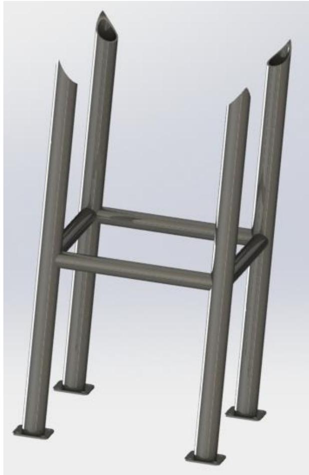
Fabricación: Se suelda centrado al fondo CU-003-A.
