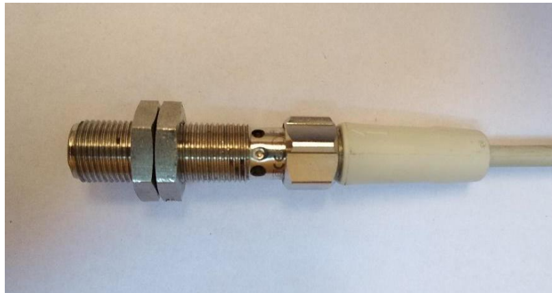
Figura 4 – Sensor inductivo IFT203
