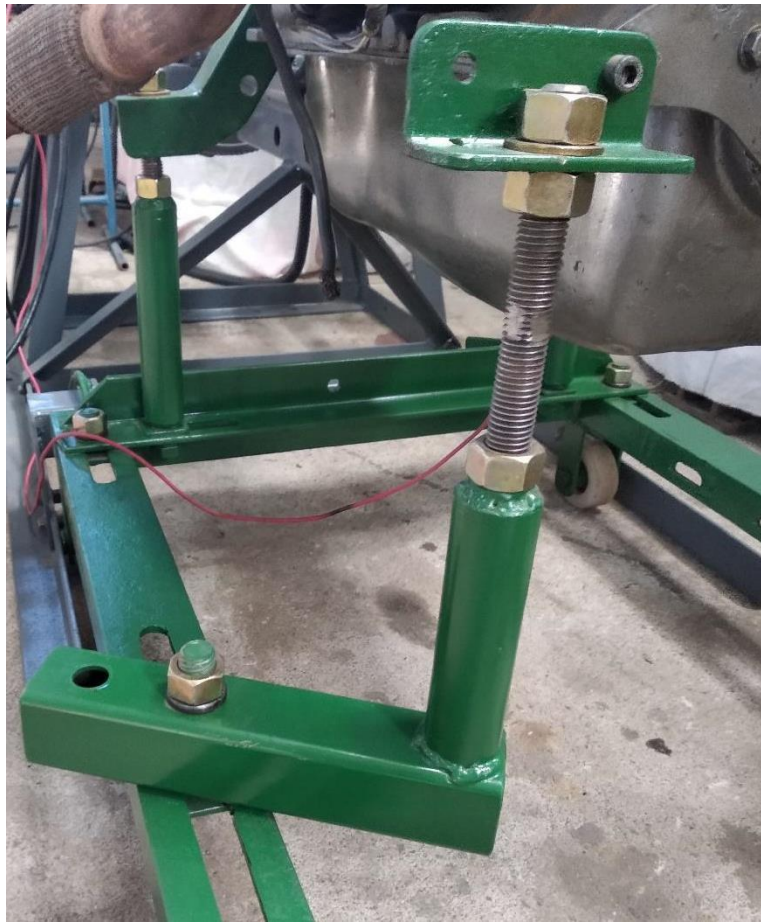
Figura 43 – Carro de fijación de motor.
