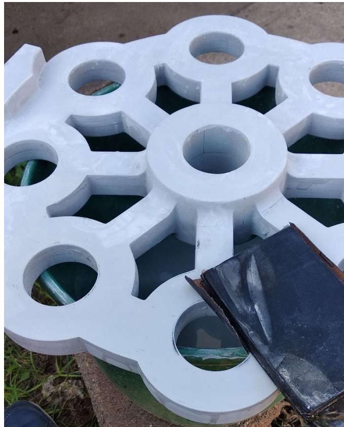
Figura 18 – Modelo 3D para fundir en aluminio.
