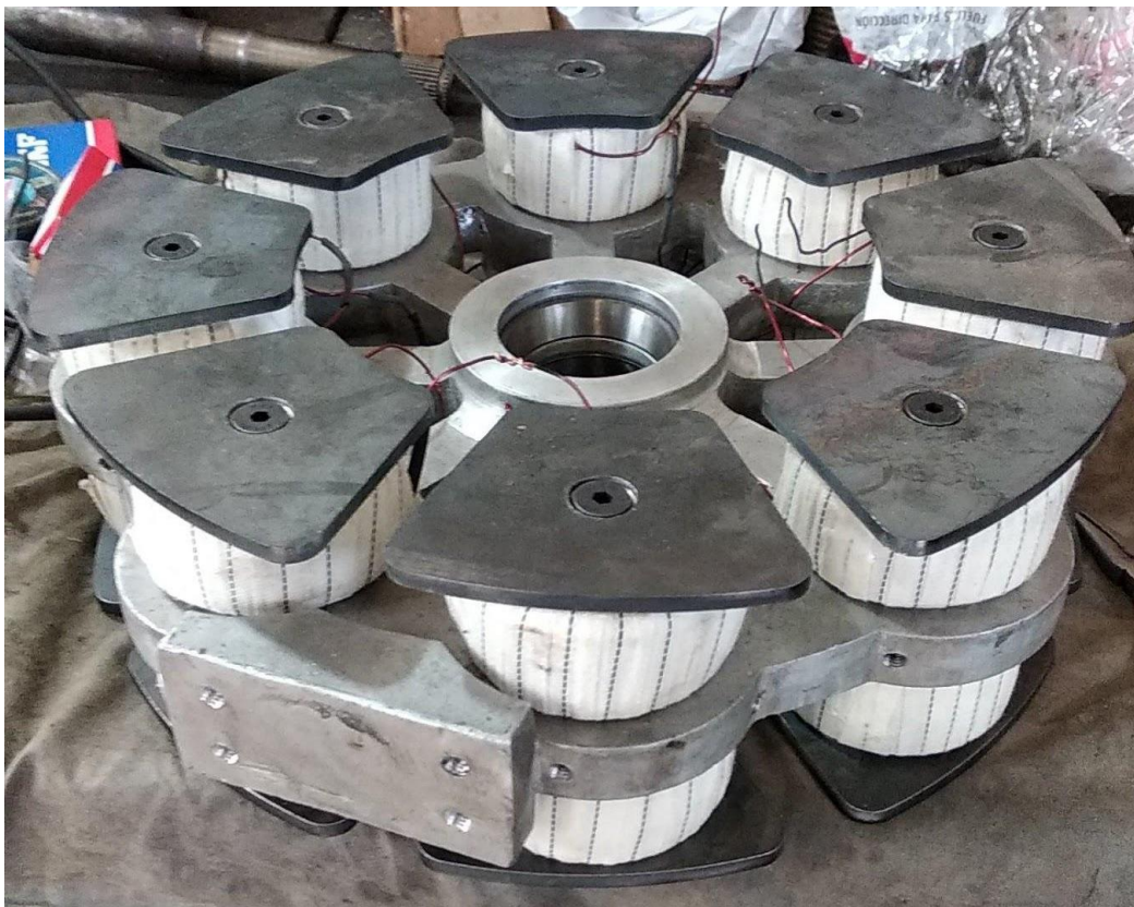
Figura 21 – Armado de estator de freno.
