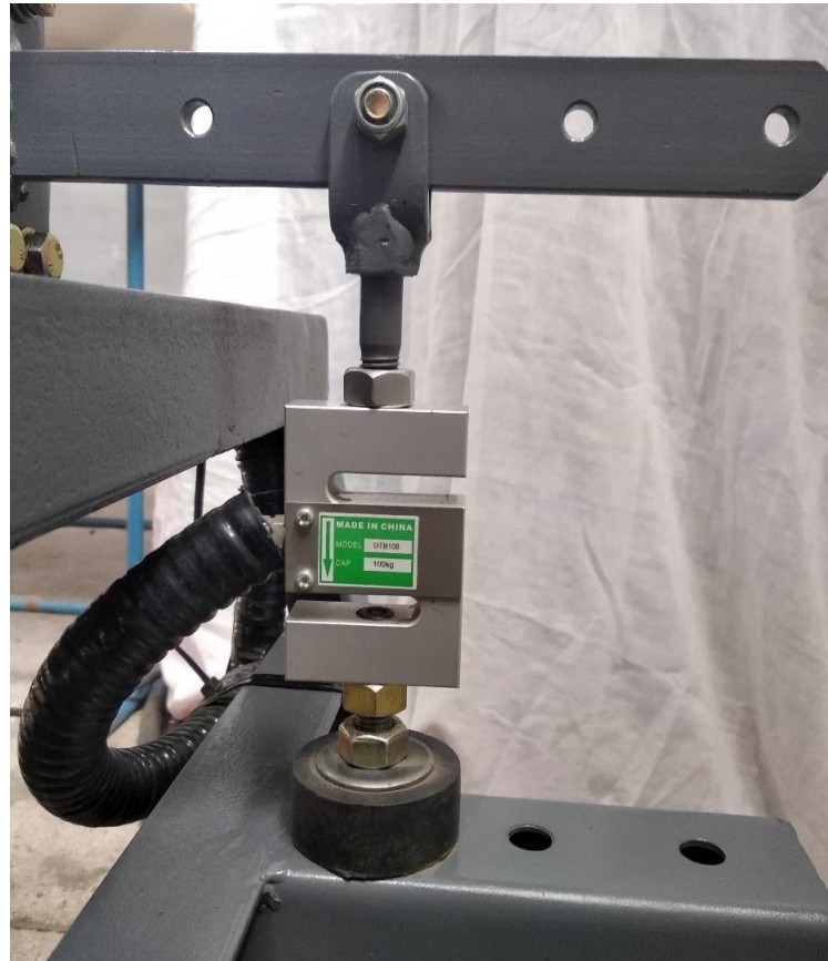
Figura 40 – Celda de carga colocada.
