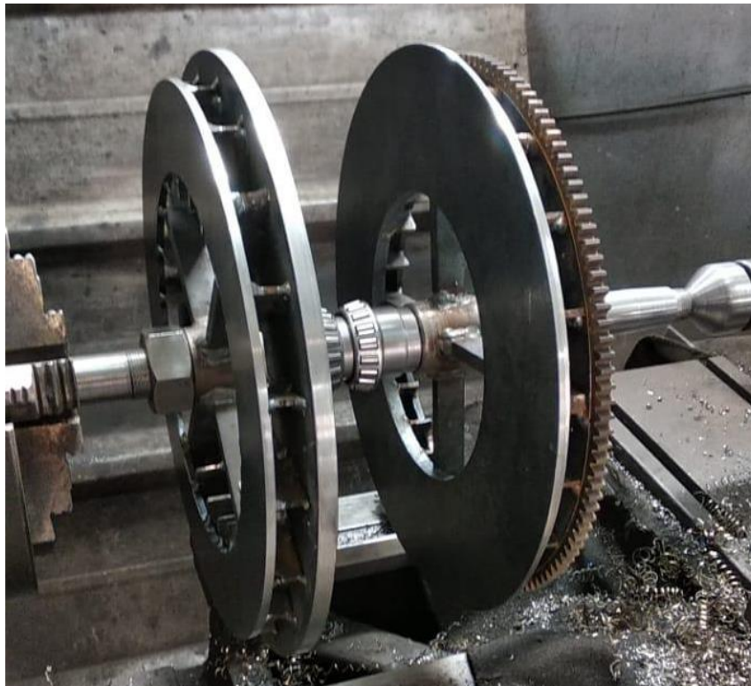
Figura 22 – Eje principal y discos ventilados.
