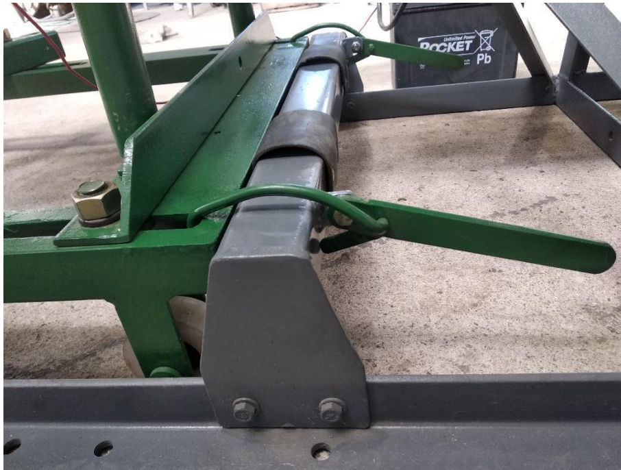
Figura 49 – Sistema de fijación de carro a soporte de freno.
