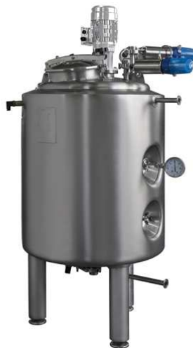
Figura 7.4.4: Madurador de aluminio
