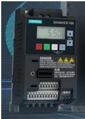
Figura 11. 5: Ejemplo de variador de frecuencia. Fuente: Siemens
