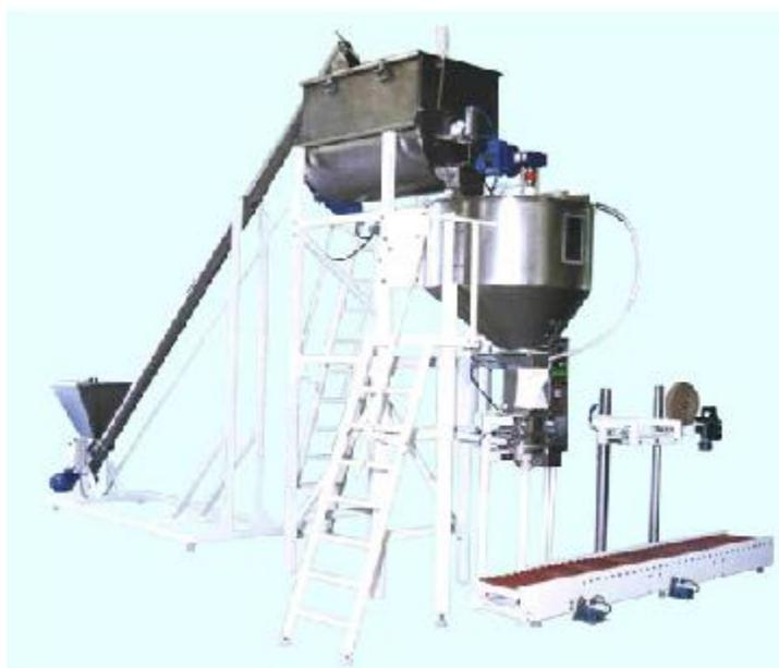
Figura 8.20. Esquema de la envasadora adoptada.
