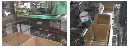
Imagen 2.3: Línea entrada de cajas paralela a cinta paso a paso.
