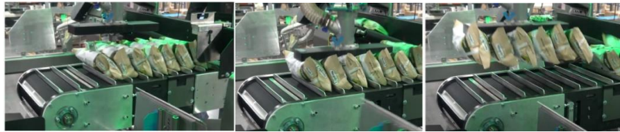
Imagen 2.1: Pinza antes y después de tomar pouches.
