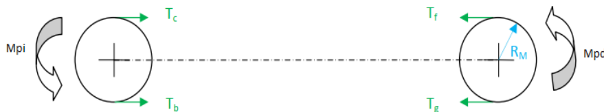
Imagen 6.1.6: Momentos aplicados a poleas motoras.
