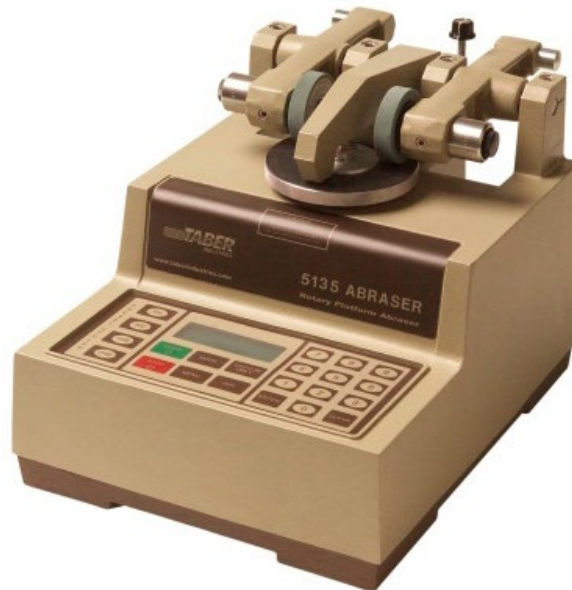
Figura 3-7. Dispositivo Taber Abraser
