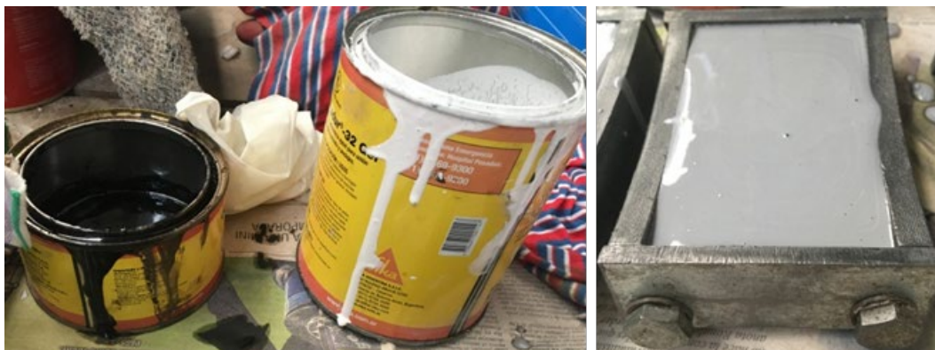
Figura 3-16. Confección de las muestras con sustrato C
