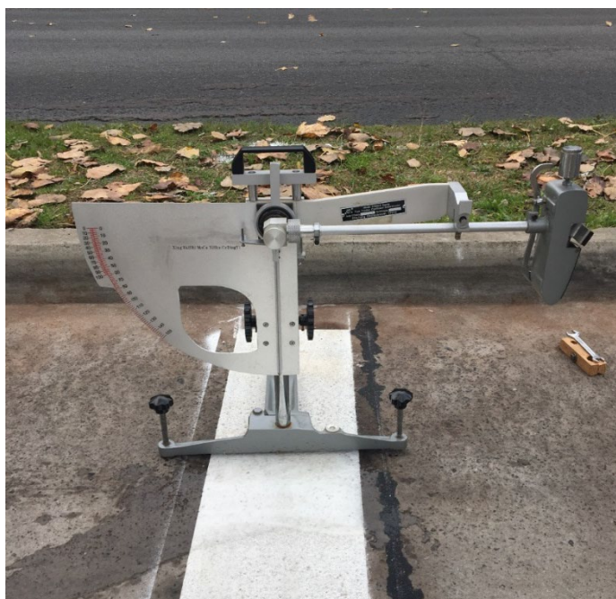
Figura 5-13. Medición de los parámetros de resistencia al deslizamiento en la dársena
