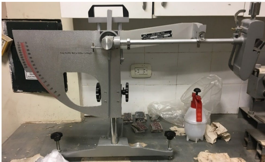
Figura 2-15. Péndulo Inglés TRRL del LEMaC
