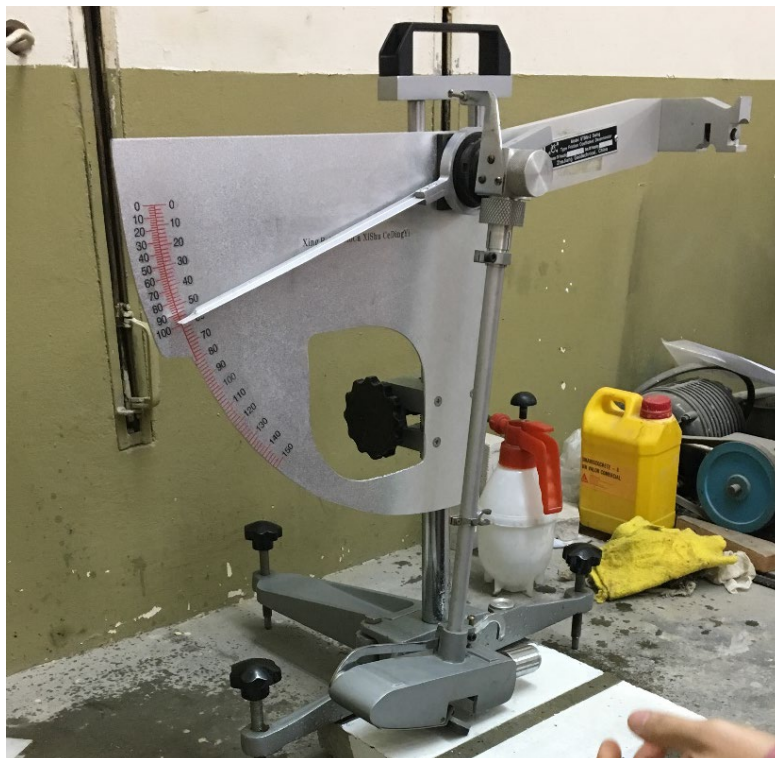
Figura 4-25. Evaluación de la resistencia al deslizamiento con el Péndulo inglés Fuente: elaboración propia
