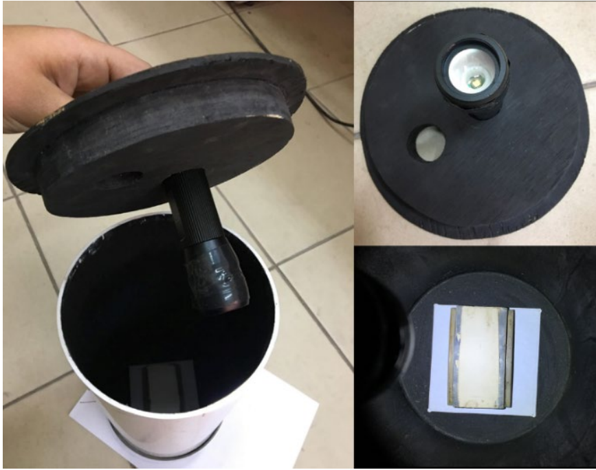
Figura 4-55. Cabina portátil utilizada para comparación visual
