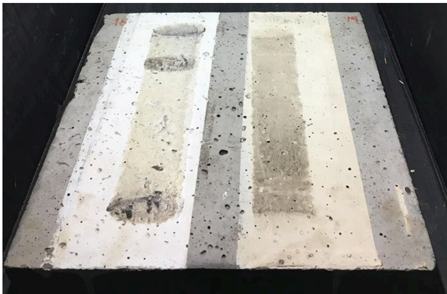
Figura 4-32: Comparación visual posterior a ensayo de la pintura base solvente (izq.) y base acuosa (der.). Fuente: elaboración propia
