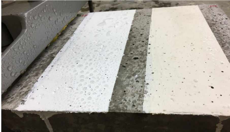
Figura 4-31. Comportamiento de la pintura base solvente (izq.) y base acuosa (der.) frente al rociado del agua. Fuente: elaboración propia
