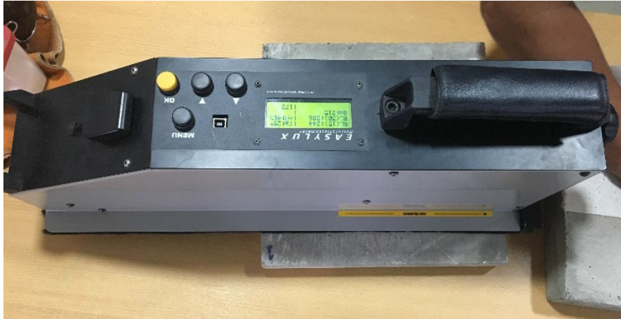
Figura 4-24. Evaluación de la retroreflexión y luminancia de las probetas con el retroreflectómetro portátil. Fuente: elaboración propia
