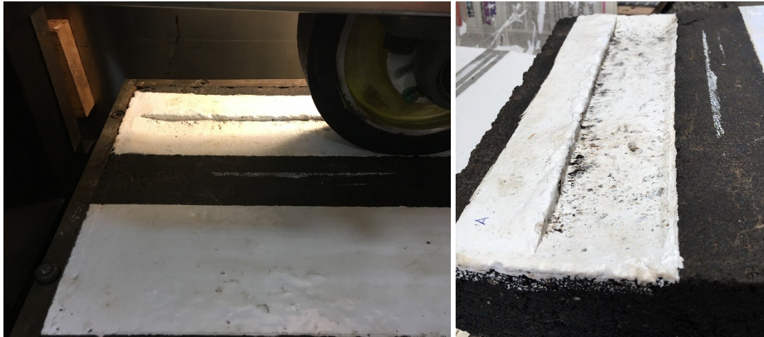
Figura 3-10. Ensayo de pintura aplicada sobre una placa de mezcla asfáltica
