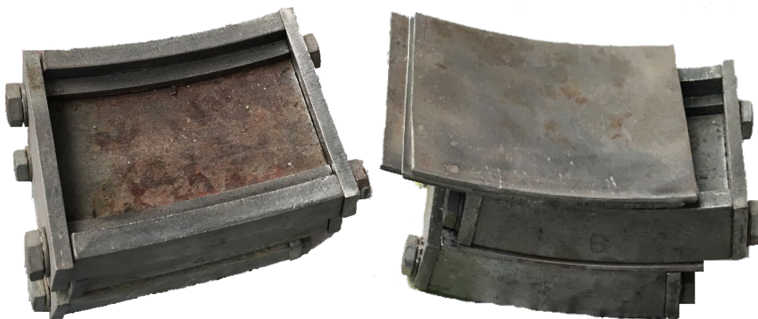
Figura 3-13. Moldes utilizados para el ensayo de Pulimento Acelerado
