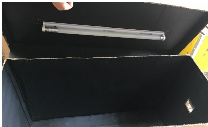
Figura A-6. Cabina de inspección visual construida para el ensayo WTT
