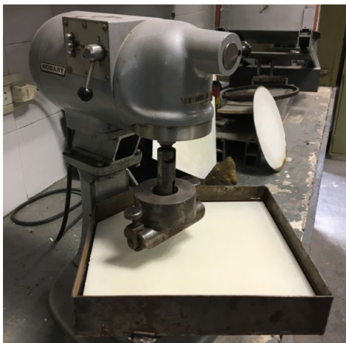
Figura 3-11. Equipo WTAT del LEMaC
