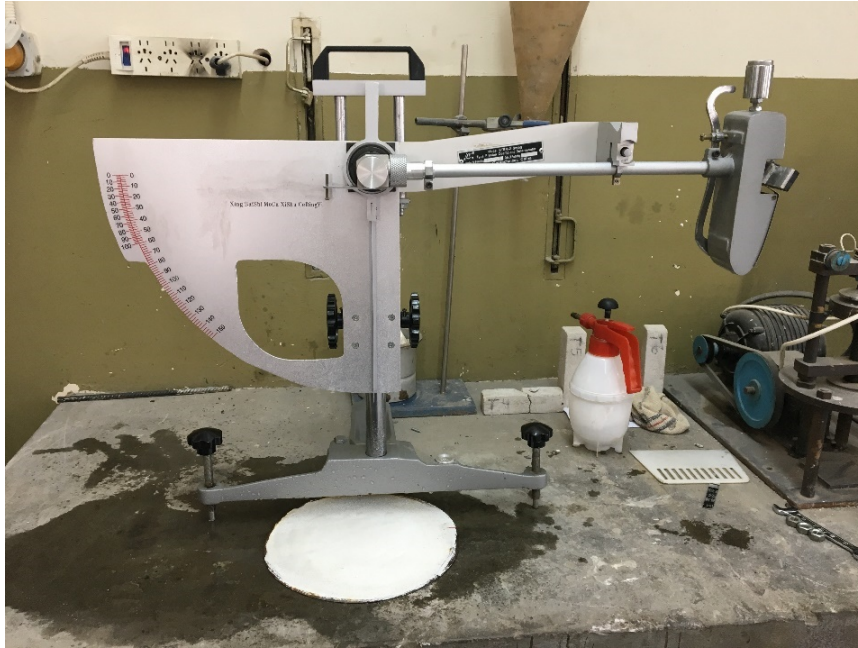
Figura 4-42. Evaluación de la resistencia al deslizamiento para el ensayo WTAT
