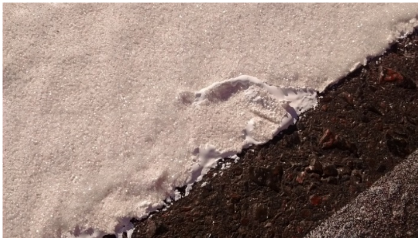
Figura 5-20. Secado de capa superficial de la Pintura A3
