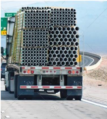
Nota: No utilizar vehículos que tengan carrocería menor al 80% de la longitud de la tubería.
