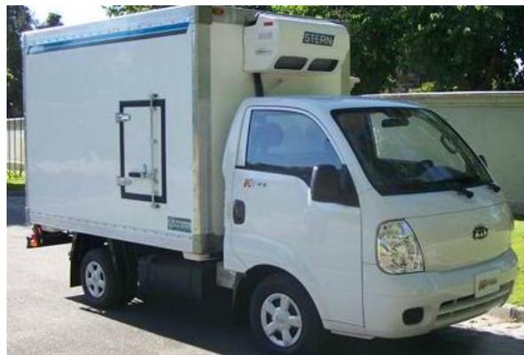
Imagen N° 20: Vehículo con cámara de frío
