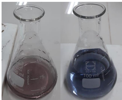
Figura 11.5. Viraje del indicador de rojo vinoso a azul.
