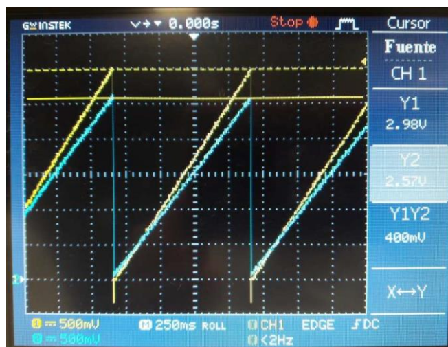
Figura 40. Comparación rampas de sierra del generador - Rshunt
