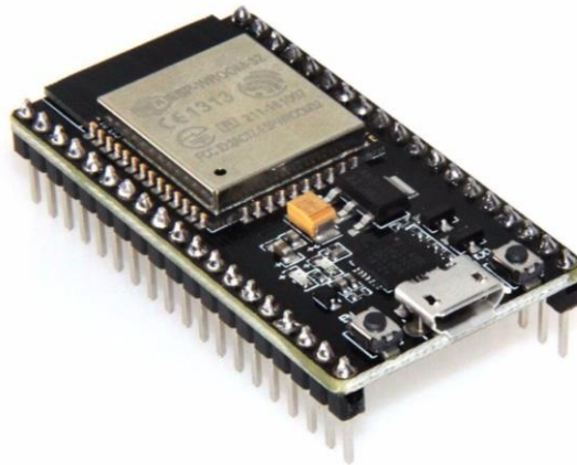
Figura 7. Microcontrolador NodeMCU ESP32.
