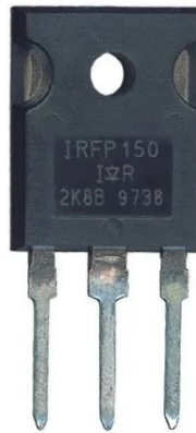
Figura 31. MosFET utilizado como carga electrónica
