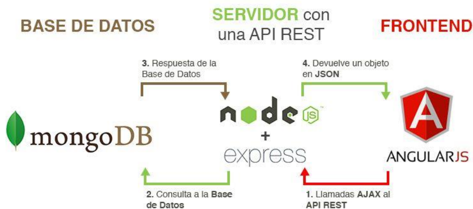
Figura 90. Estructura de comunicación Front-end y Back-end [9]
