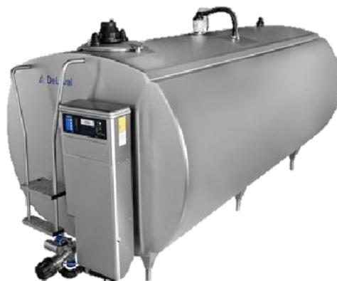
Tanque de Frío de 10.000 litros de capacidad. Modelo DXCEM de conexión trifásica con 4 HP de potencia. Es un tanque de acero inoxidable, de calidad sanitaria y aislación térmica.
