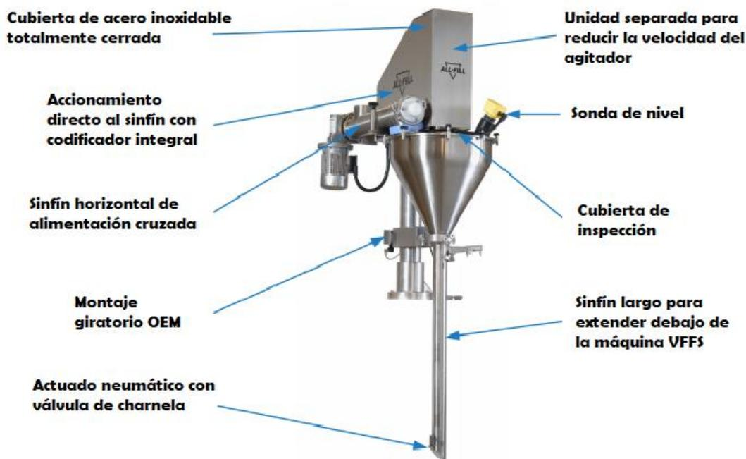
Imagen 8.33 - Envasadora adoptada y sus partes principales. Fuente: ALL – FILL.
