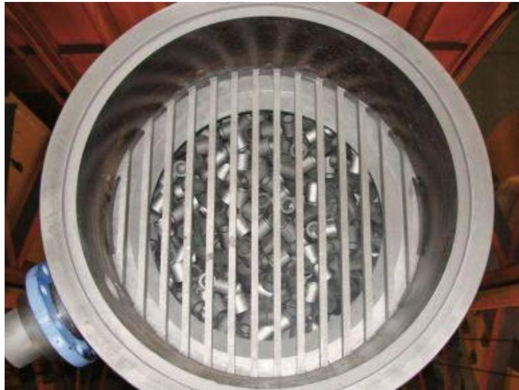
Imagen 8.15- Corte transversal de la columna rellena.
