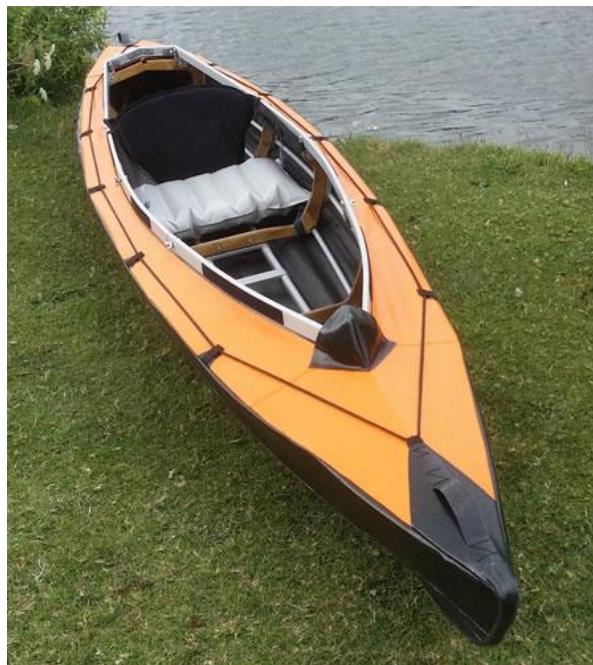
Figura 4.5 – 3 Ejemplo de un kayak estructural desarmable armado
