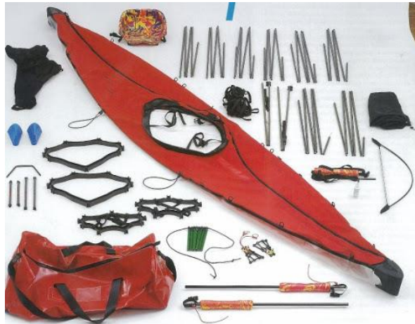
Figura 4.5 – 2 Ejemplo componentes de un kayak estructural desarmable
