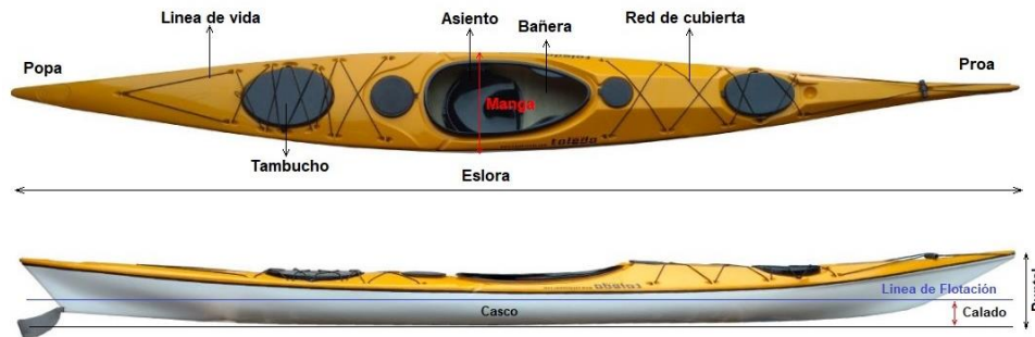
Figura 2.1.1 - 1 Kayak de travesía y sus componentes
