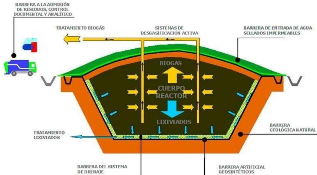
Figura 27. Esquema corte de un vertedero controlado.
