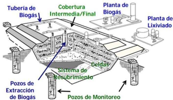
Figura 29. Esquema vertedero controlado con aprovechamiento del biogás. (Weihs, 2011)
