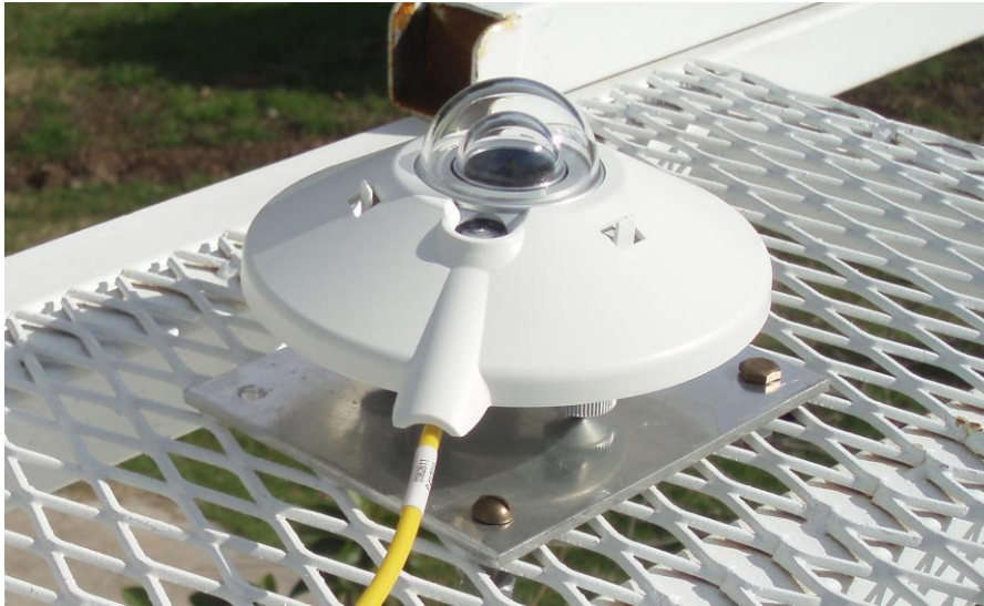
Figura 1. Piranómetro Kipp & Zonen CM11 ubicado en la división CEILAP del CITEDEF utilizado para realizar las mediciones de irradiancia instantánea en el rango de longitudes de onda de 300nm a 3000nm.
