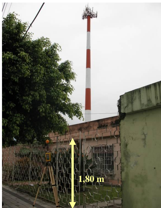
Figura 3: EMR 300 realizando una medición a la altura establecida.
