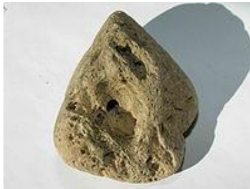
Figura 3. Vista de un trozo de pomeca puzolánica
