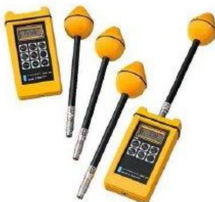
Figura 1: Equipo Narda EMR 300 y sus sondas. Tomado de: www.narda-sts.com
