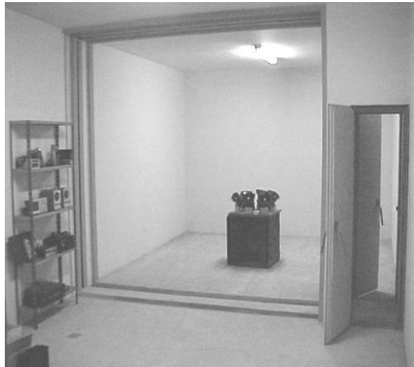
Figura 2. Recinto del Laboratorio de Acústica y Sonido de la UTN – FRM en donde se realizan los ensayos de determinación del aislamiento acústico normalizado
