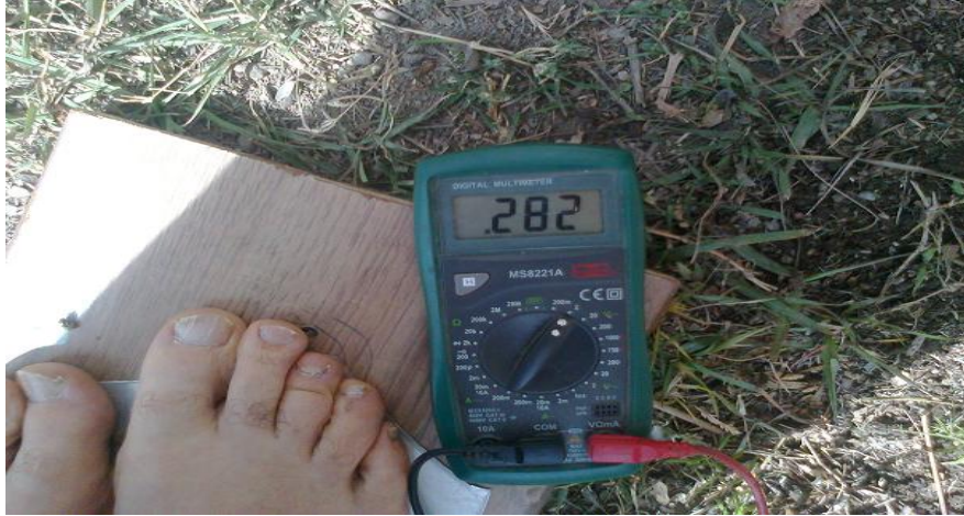
Figura 12. Persona descalza sobre lámina de aluminio aislada en contacto con un micro voltímetro unido a una jabalina puesta a tierra.
