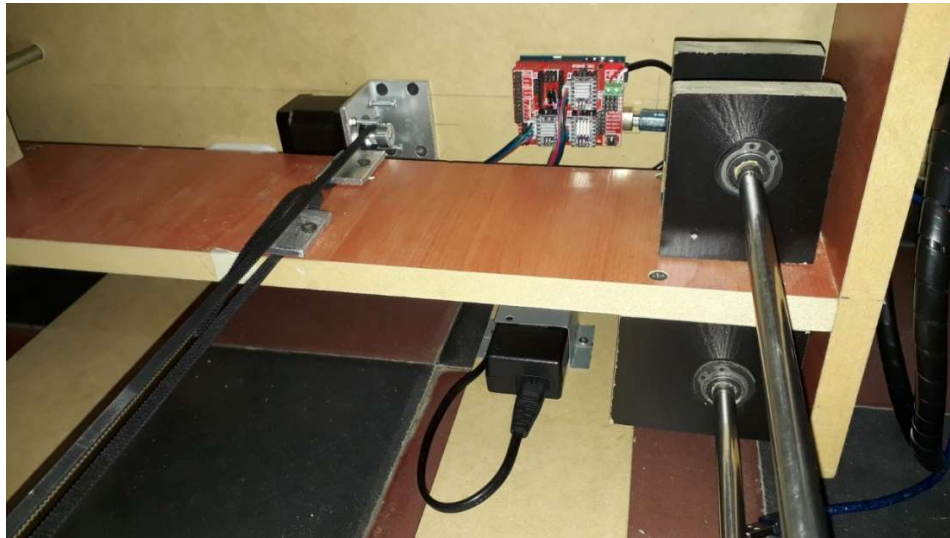
Figura 31- vista rodamientos lineales
