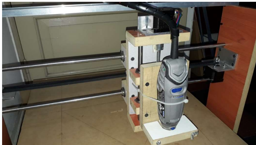
Figura 29 Deslizamiento eje x
