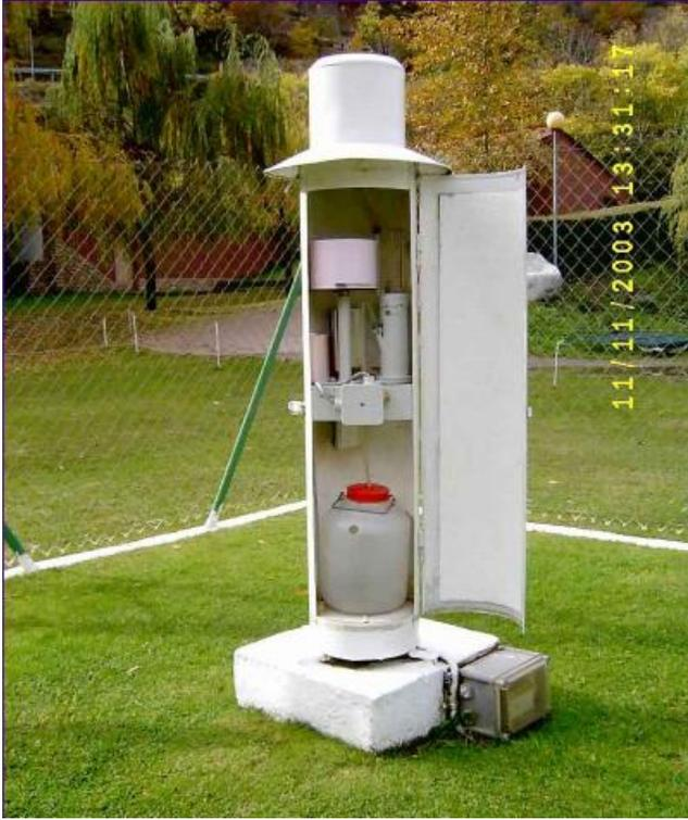
Figura 4. Pluviógrafo (Baylina, 2003)
