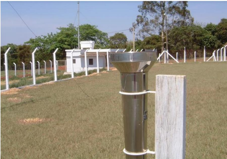
Figura 3. Pluviómetro. (Pepa, 2013)
