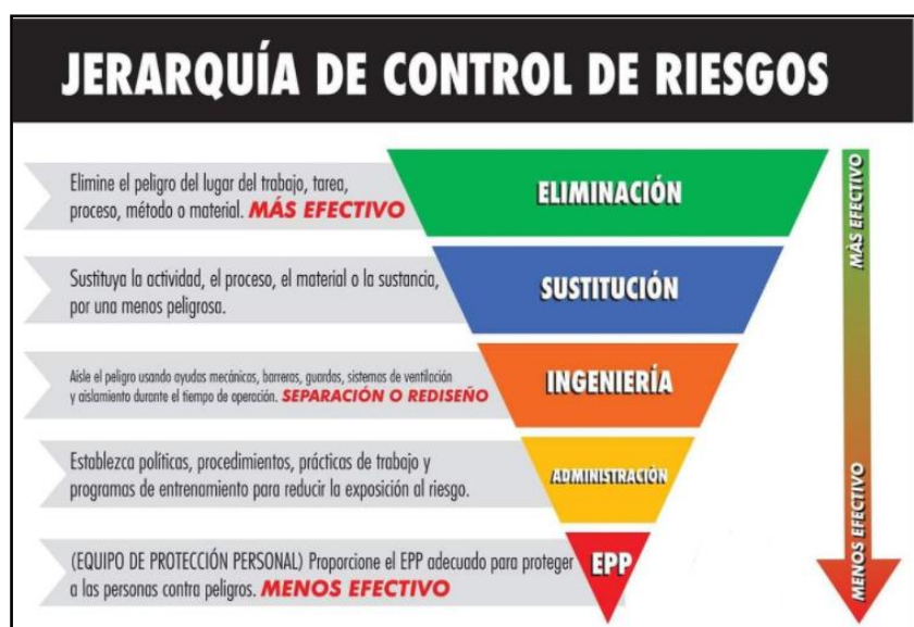
Figura 4: Jerarquía de control de Riesgos – Corporación de Asesores en Protección y seguridad
