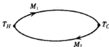
Figura 2: Circuito de termopar sencillo. Referencias: M_1 Metal 1, M_2 Metal 2, T_H Temperatura a medir, T_C Temperatura de referencia.
