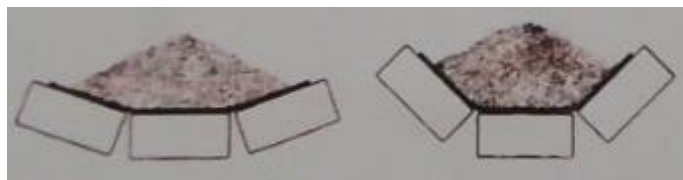
Ilustración 2: Transportador de banda abarquillado.
