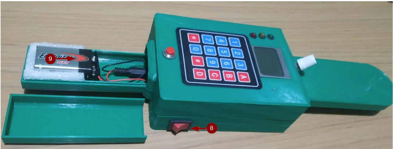
Imagen 36: Compartimiento de batería.
