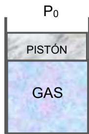
Fig. 1.24: el gas del recipiente se calienta isobáricamente hasta duplicar su volumen.
