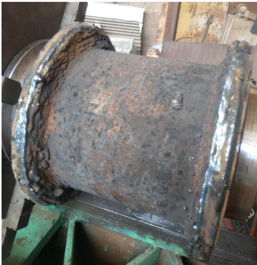
Figura 78: Cámara de compresión rellanada. Vista 3.
