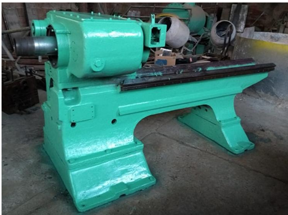
Figura 5: Vista lateral del torno después de la restauración.
