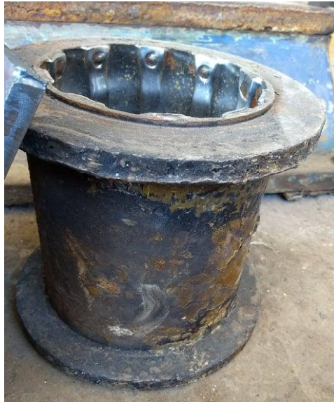
Figura 7: Cámara de compresión de extrusor de soja.
