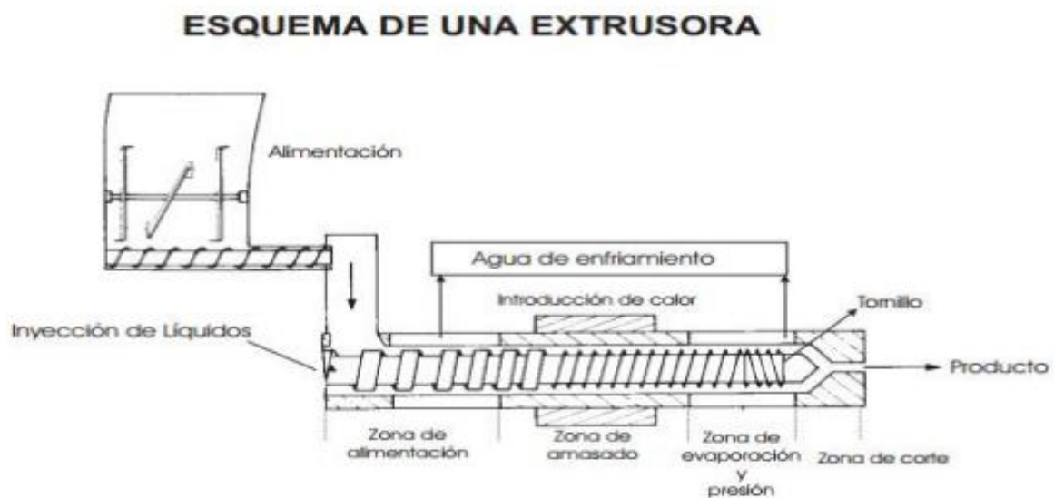
Figura 8: Esquema de una Extrusora.
