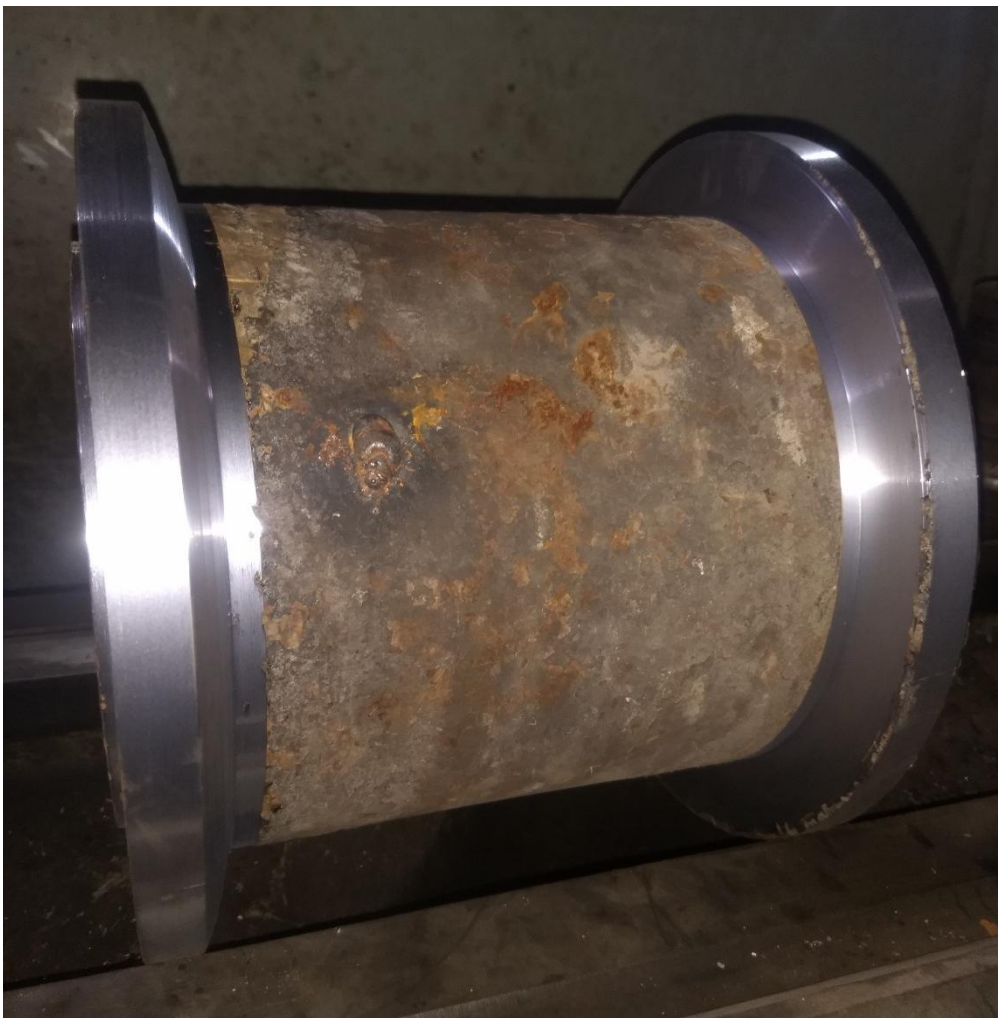
Figura 79: Cámara de compresión rellanada y rectificada.
