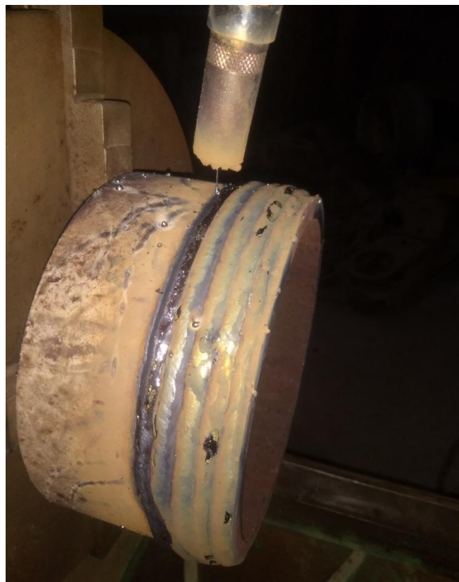
Figura 66: Prueba de espesor del cordón de soldadura.
