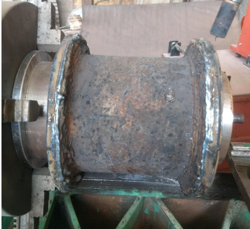
Figura 77: Cámara de compresión rellanada. Vista 2.
