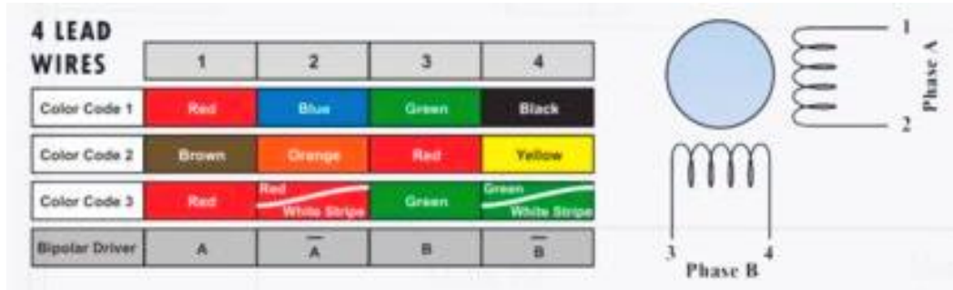
Figura 45: Color de cables de motores PaP bipolares.
