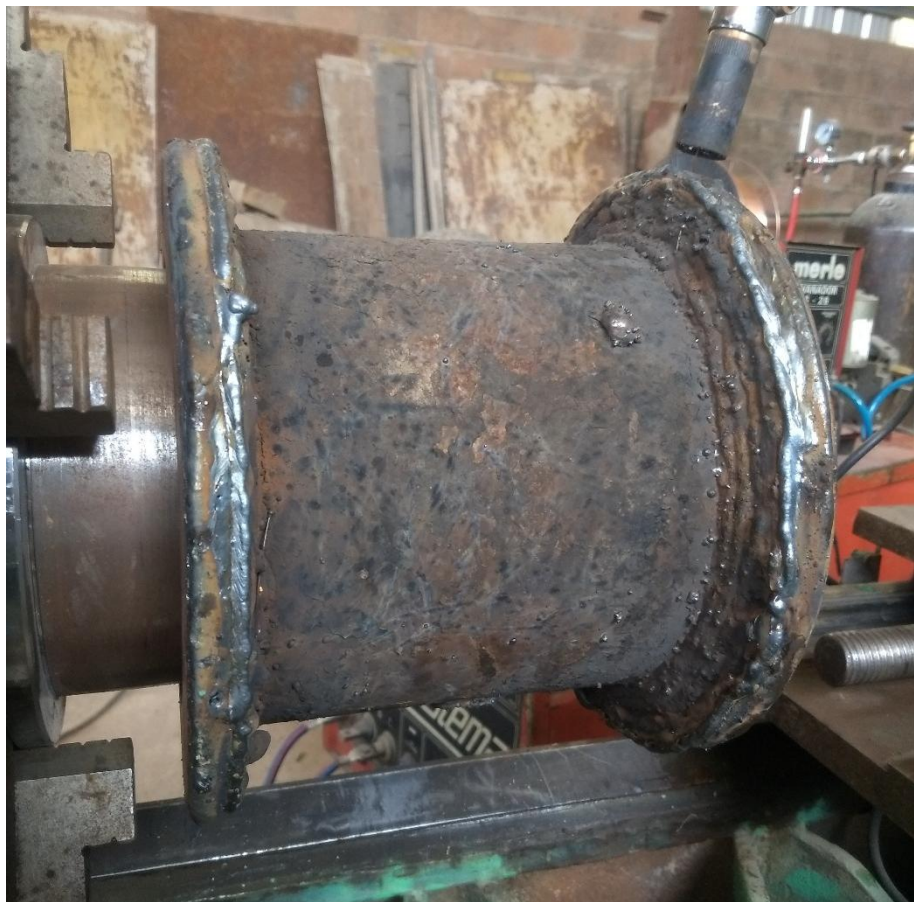
Figura 76: Cámara de compresión rellena. Vista 1.
