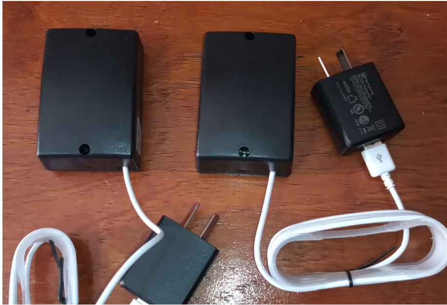
Figura 16: nodos para ampliación de la red
