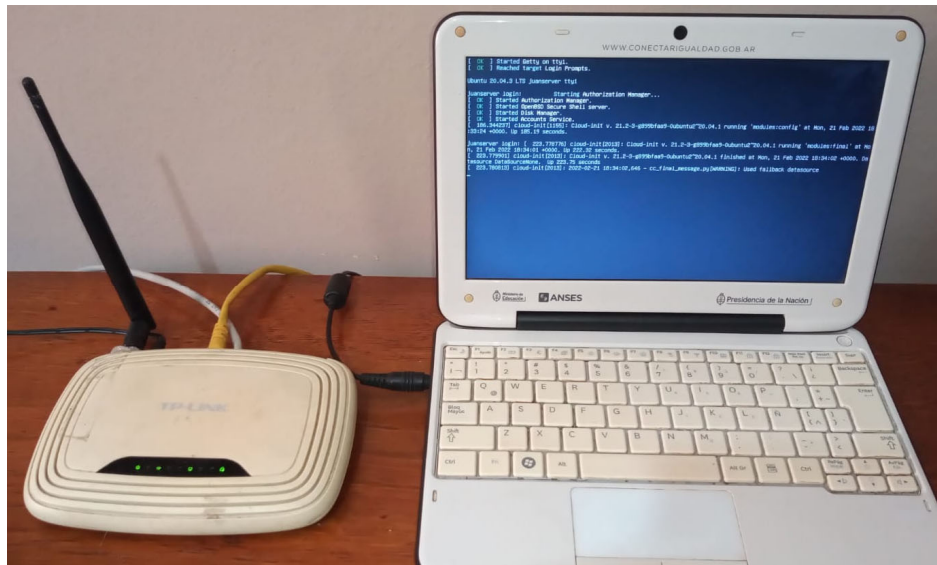
Figura 15: netbook utilizada como servidor y router principal de la red
