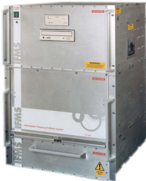
Figura 2.12: Sistema de módems de frecuencias intermedias (del inglés *Intermediate Frequency and Modem System - IFMS*), ubicado en la sala de equipamiento principal.
