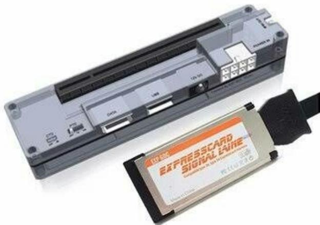
Figura 4.7: Adaptador EXP GDC BEAST V8.0 Expresscard, es un equipo adaptador de gráficos externo para computadoras portátiles, dispositivo de expansión PCI-E.
