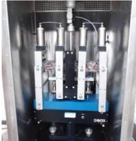
**Fig. 2.** Método de cuantificación de fatiga por medio de la viga de cuatro puntos
