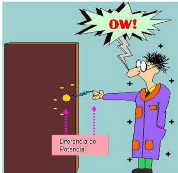
Figura 5.34: Descarga producida por la diferencia de potencial entre la manija y el cuerpo de la persona
