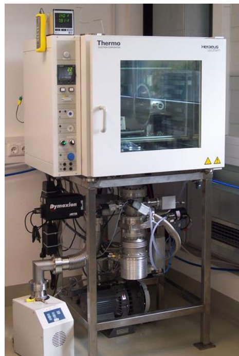
Figura 7.29: Horno de vacío utilizado en procesos de bakeout
