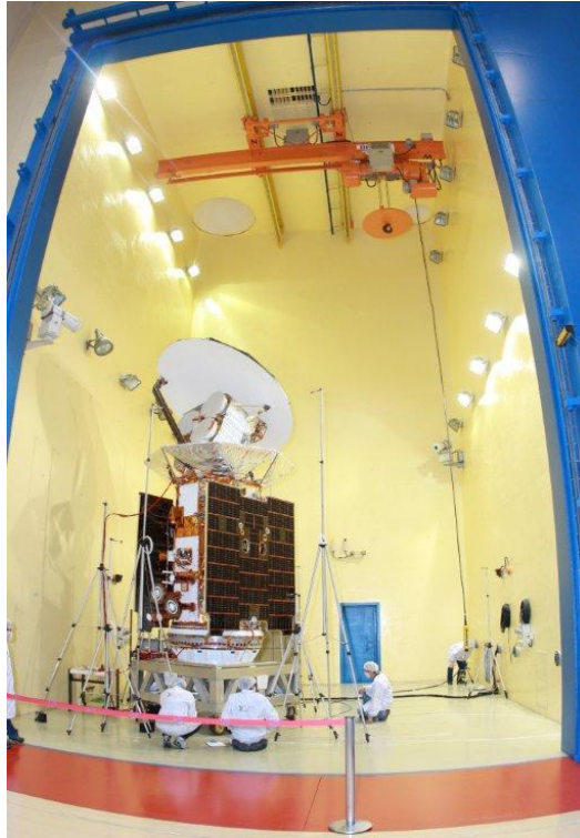
Figura 5.24: Satélite SAC-D en cámara para ensayos acústicos (Imagen INPE)
