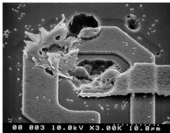
Figura 5.37: Daño en las uniones metálicas internas de la memoria luego de un ensayo ESD donde se implementó una descarga de 8000 voltios, 3 veces. Fuente: Jet Propulsion Laboratory
