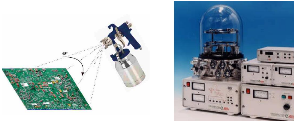
Figura 7.11: Deposición con spray o por vacío
