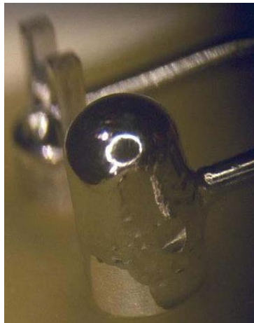
Soldadura en unión de alto voltaje en terminal bifurcado
