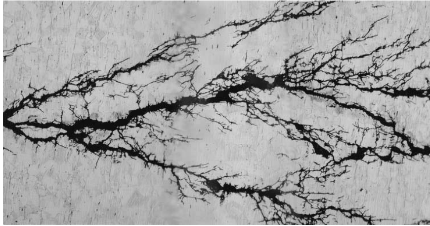
Figura 6.4: Típico patrón de grietas presente en materiales con SCC
