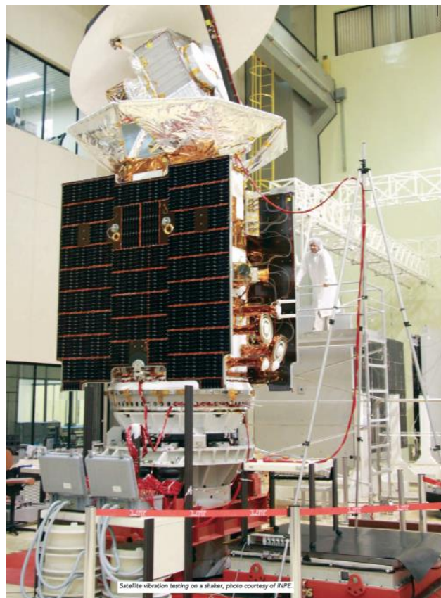
Figura 5.23: Satélite SAC-D montado sobre shaker (Imagen INPE)
