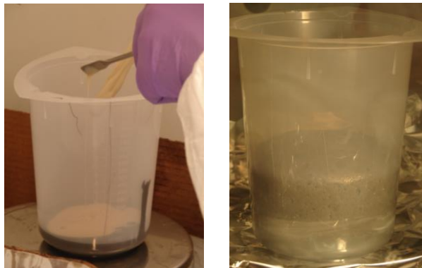
Figura 7.64: Scotch-Weld 2216 B/A Gray, proceso de mezcla y desgaseado
