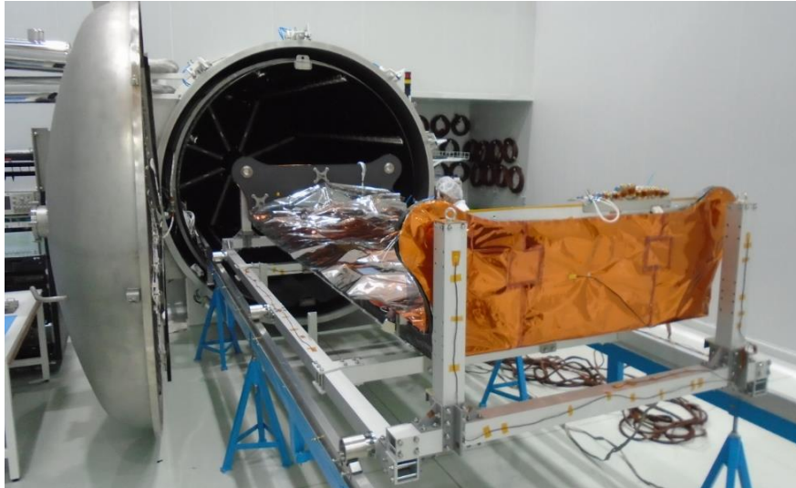
Figura 5.22: Cámara de termo-vacío (Imagen CONAE)
