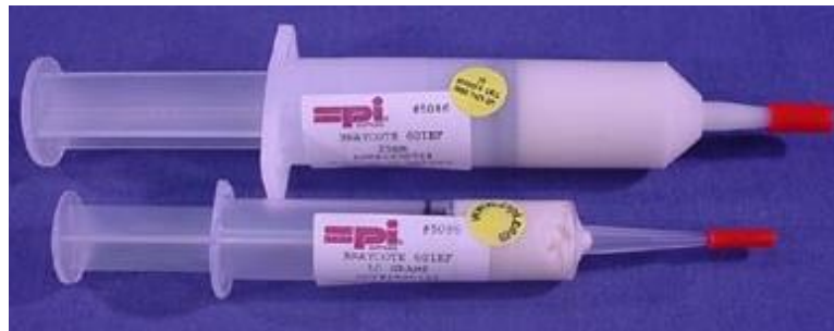
Figura 7.27: Grasa de alta performance en vacío Braycote 601EF. Temperatura operativa: de -80°C a 204°C. TML:0.41, CVCM:0.07 (NASA 1124). Presión de vaporización: 4 \times 10^{-13} [torr] a 20°C
