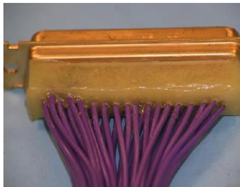
Figura 7.21: Poteado de conector Sub-D
