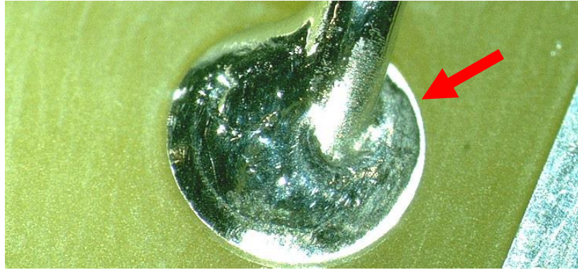
Figura 7.49: Soldadura fría, presenta un aspecto opaco y el estaño no a fluido adecuadamente sobre el conductor
