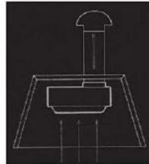
Extractores de cocina con descarga por tubería.
