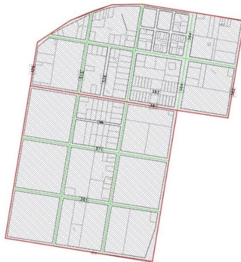
Figura 6.3.2.a: Esquema de malla cerrada en zona a intervenir Fuente: Propia
