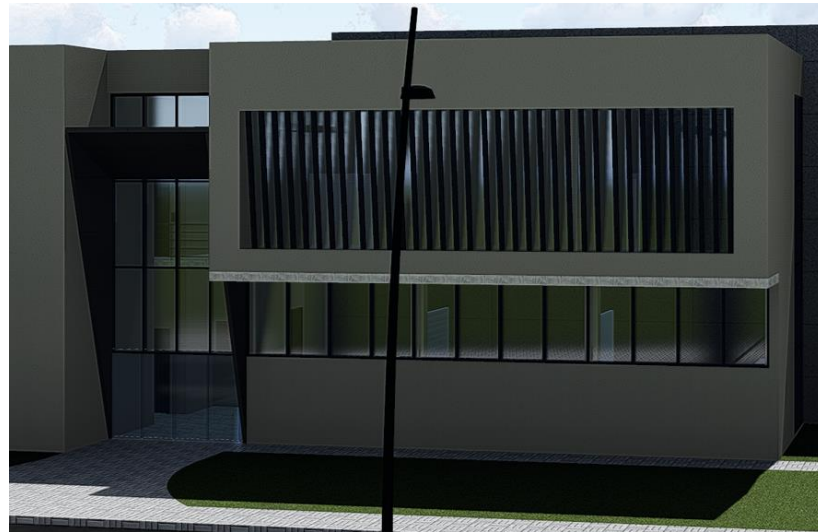
Figura 5.4.b: Cerramiento oficinas y parasoles Fuente: Propia (Lumion)
