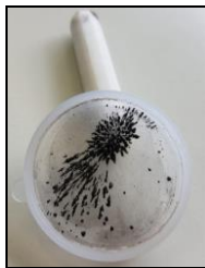
Figura 4. Respuesta de las MNPs preparadas ante un estímulo magnético.
