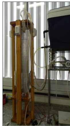
Figura 6. Sistema de reacción foto-catalítico empleado para radiación UV-Vis.
