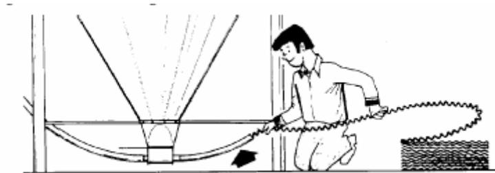
Para instalarlo, deslice el sinfín dentro de los tubos desde el extremo posterior del cargador con movimientos cortos.
