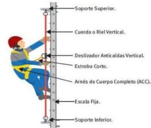
Ilustración 34. Sistema personal para detención de caídas.
