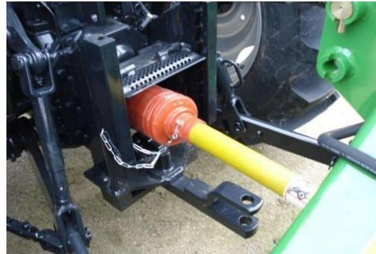
Ilustración 37. Protección en cardan de tractor
