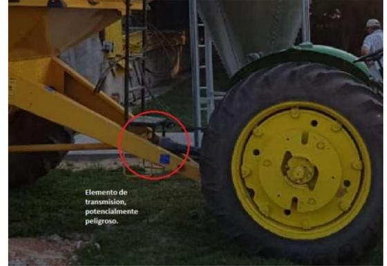
Ilustración 31. Órganos de máquinas en movimiento.
