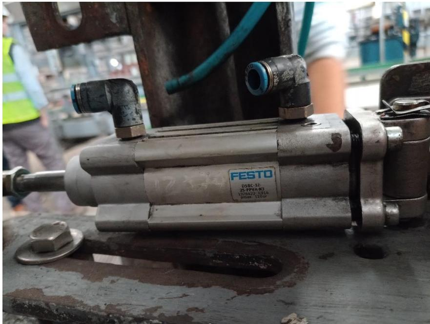
Figura 2.1.18: Cilindro neumático.
