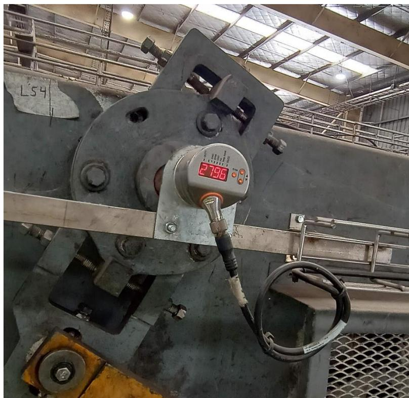
Figura 3.2: Encóder incremental montado en máquina
