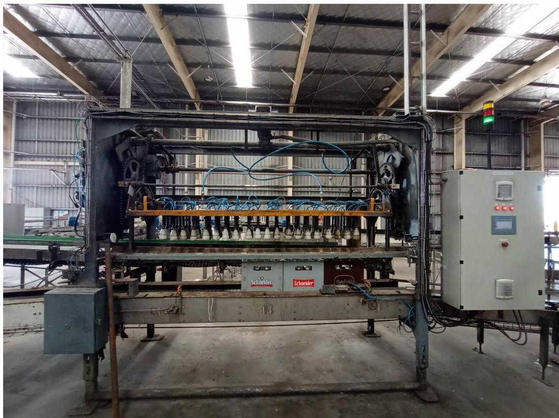
Figura 3.1: Máquina descajonadora finalizada.
