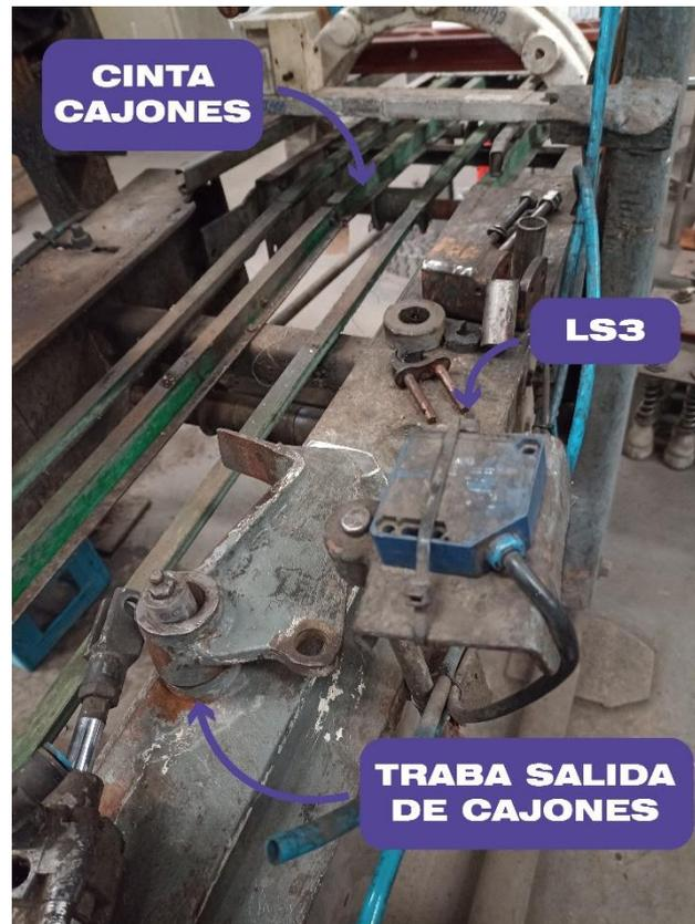
Figura 2.1.10: Sensor LS3 y traba de salida de cajones.
