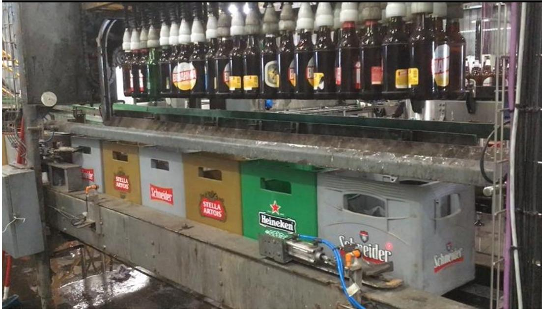
*Figura 2.6.1: Fotografía puesta en marcha de máquina desencajadora.*
