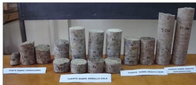
Figura 5: Probetas extraídas para ensayo de compresión simple y RAS de los diferentes puentes.
