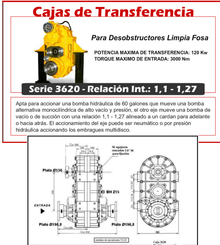
Figura 4.47 (Datos técnicos caja de transferencia) [18]
