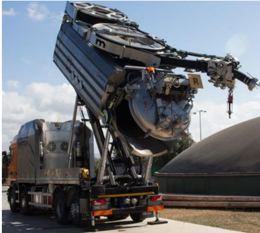
Figura 1.7 SUCCIONADOR MARCA KAISER-MORO (Fusión Alemana-Italiana) CON TURBINA ACCIONADA POR CAJA DE TRANSFERENCIA EN TRANSMISIÓN CARDÁNICA DEL CAMIÓN [2]
