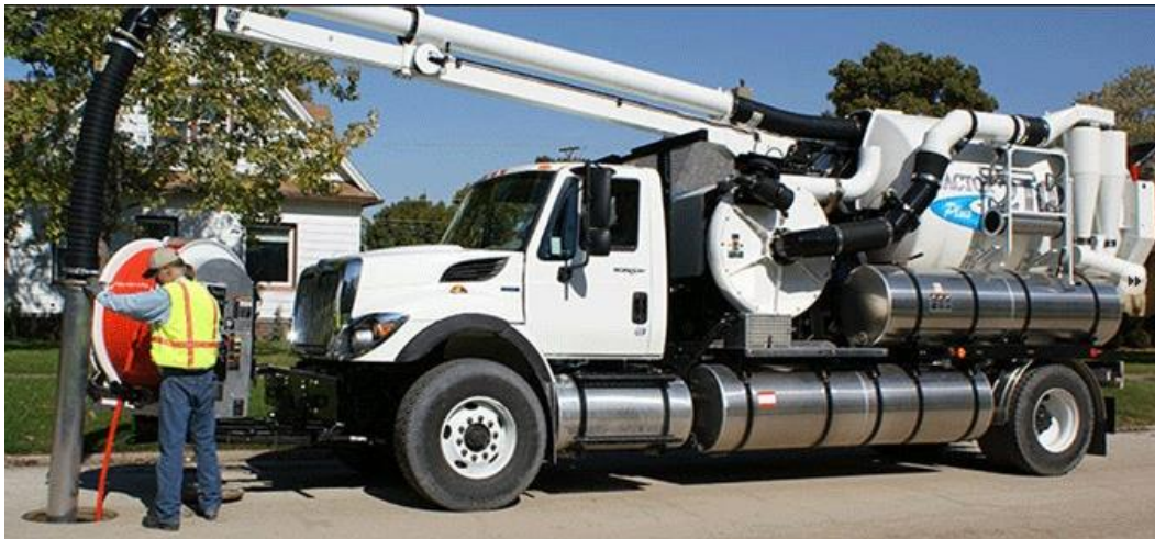
Figura 1.6 SUCCIONADOR DESOBSTRUCTOR CON TURBINA Y TRANSMISIÓN HIDROSTÁTICA MARCA VACTOR (Origen EEUU) [1]
