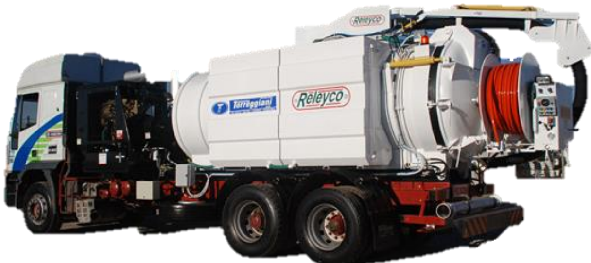
Figura 1.8 SUCCIONADOR - DESOBSTRUCTOR CON TURBINA Y MOTOR AUXILIAR A EXPLOSIÓN MARCA RELEYCO (Origen Argentina) [3]
