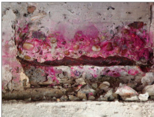
Fig. 17 Ensayos de carbonatación en las vigas de borde sobre los estribos.
