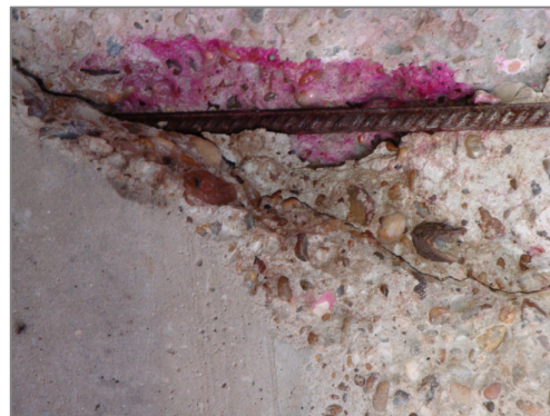
Fig. 17 Ensayos de carbonatación en las vigas de borde sobre los estribos.
