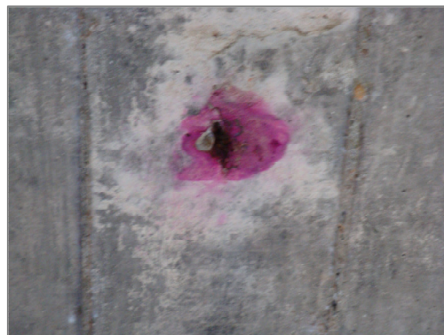
Fig. 9 Vista del primer punto descubierto rociado con solución indicadora.
