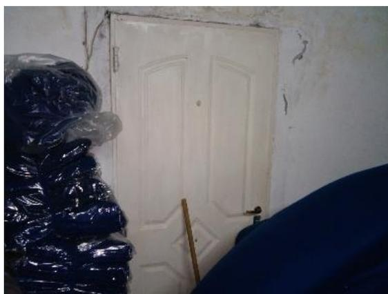
Figura 8: Salidas bloqueadas y sin señalización..
