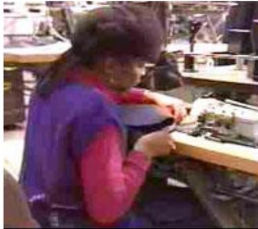
Figura 49: Mesa demasiado alta codo izquierdo del trabajador levantado.
