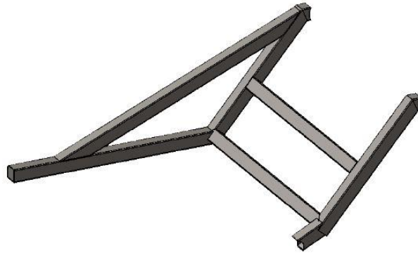
Ilustración 66. Estructura del pinche
