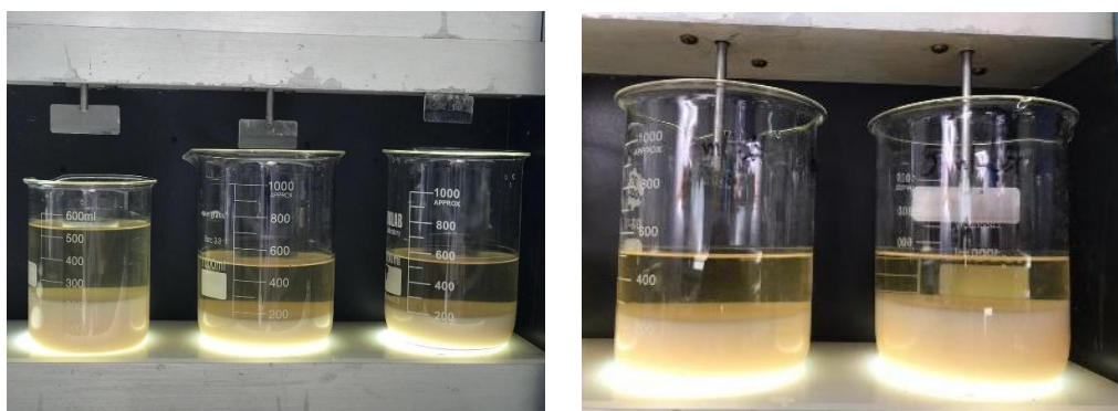
Figura 5. Resultados de coagulación-floculación con fango sedimentado y sobrenadante.
