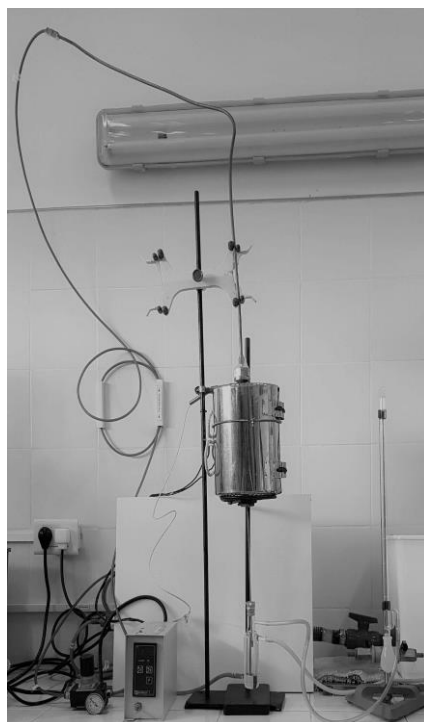
Figure 3. Fotografía del sistema de conexión completo para pirólisis de residuos ligno-celulósicos.
