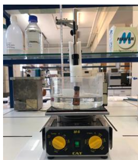
Figura 1. Extracción SPME utilizando un soporte manual, una placa de agitación y calentamiento con un termómetro para controlar la temperatura y viales ámbar de 4 mL
