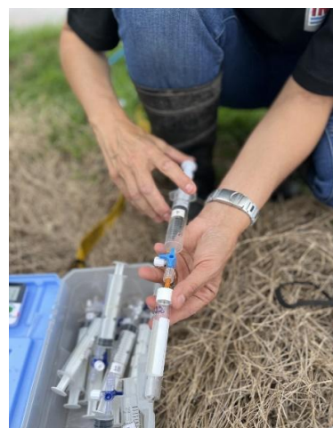
Figura 2. Equipo de medición de GEI con cámaras estáticas (izq.) e inyección de muestra en vial (der.)
