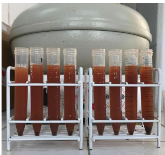
Figura 1. Tubos con solución de ácido y material adsorbente previo a la centrifugación.
