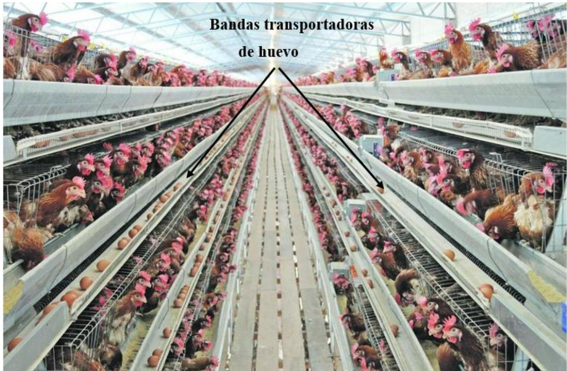
*Ilustración 27: Bandas transportadoras de huevo*
