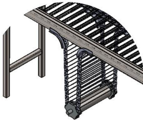
*Ilustración 131 - Sistema tensor transportador*
