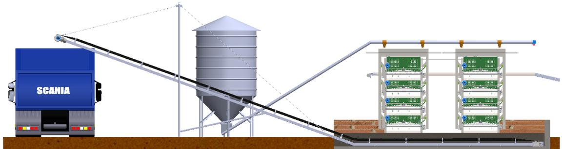
*Ilustración 128 - Cinta extractora de guano en ensamble*
