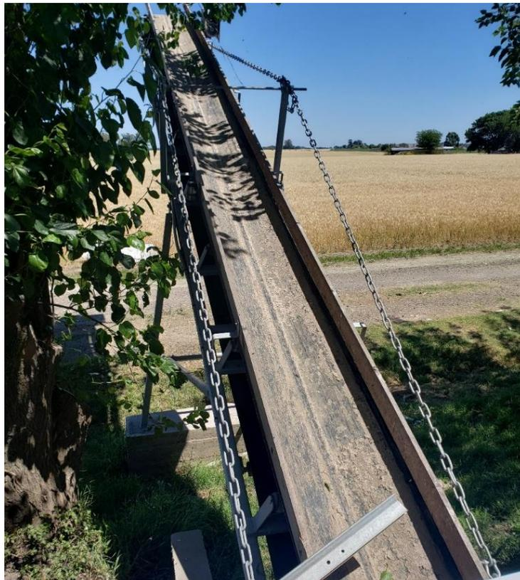
*Ilustración 50: Banda extractora de guano.*
