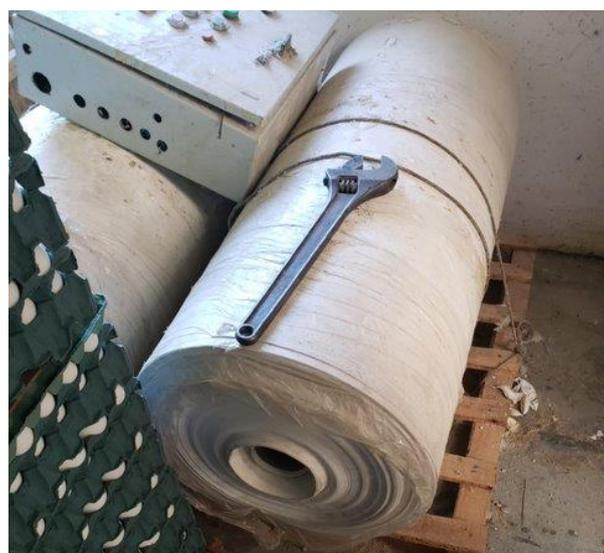
*Ilustración 39: Rollos de bandas transportadoras*
