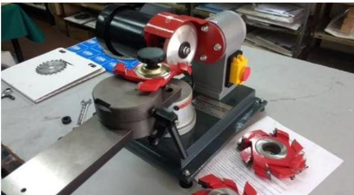
Para el afilado de las sierras de banda o alternativas se utilizará la afiladora Wood Mizer BMS500.
