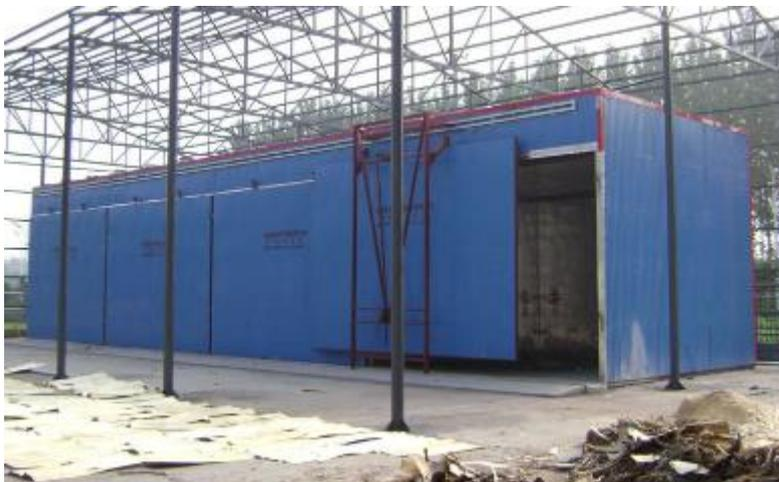
Este horno tiene capacidad para hasta 50 metros cúbicos de madera por sus medidas de 6,5 metros de largo por 6 metros de ancho y 4,5 m de alto. El horno cuenta con un sistema de calefacción de 90 kW de energía.
