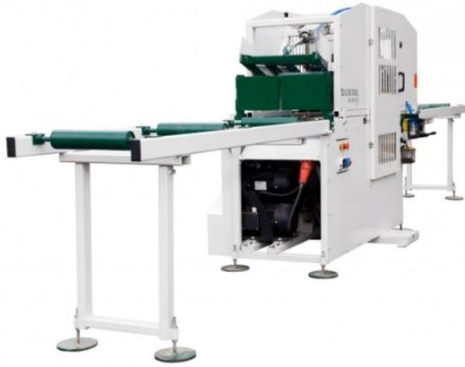
Esta máquina permite la realización de hasta 14 cortes al mismo tiempo gracias a sus 16 sierras alternativas que tienen distanciados totalmente ajustables, por lo que es muy flexible y nos permitirá obtener todos los cortes necesarios para la fabricación del producto final.
