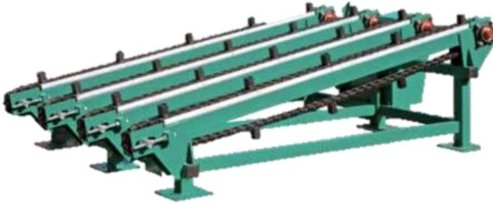
Para el movimiento horizontal de la materia en proceso será utilizada como una de las posibilidades la Wood Mizer Cross Transfer Deck.
