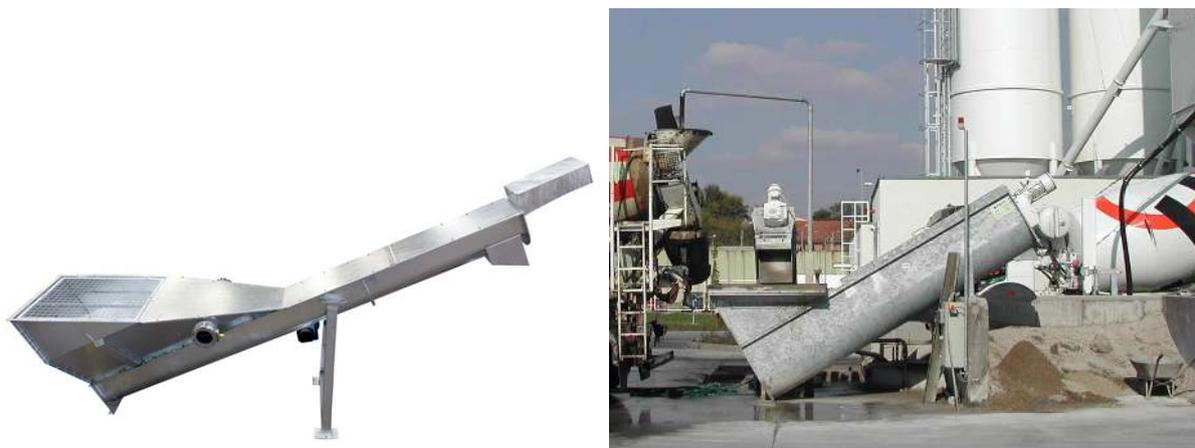
Imagen 32. Sistema de tolva + tornillo sin fin separador de áridos gruesos.
