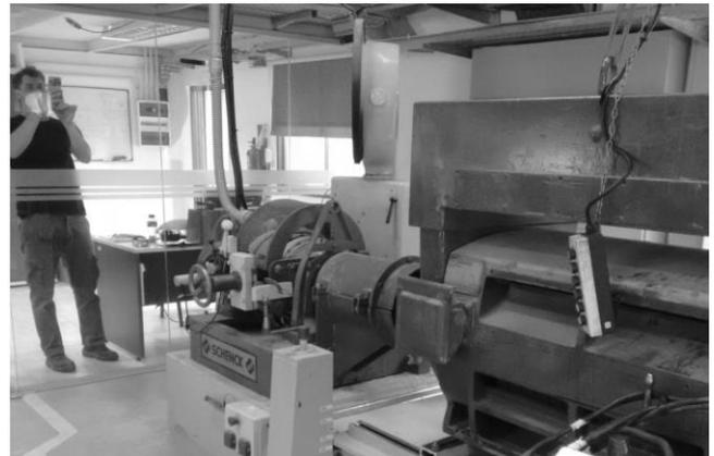
**Figura 2: Dinamómetro principal de la sala de ensayo, con un motor acoplado.**
