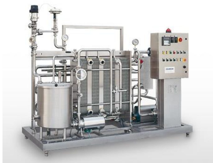
Ilustración 31: Equipo utilizado en la pasteurización
