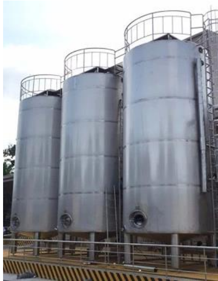
Ilustración 24: Tanques de almacenamiento de leche cruda
