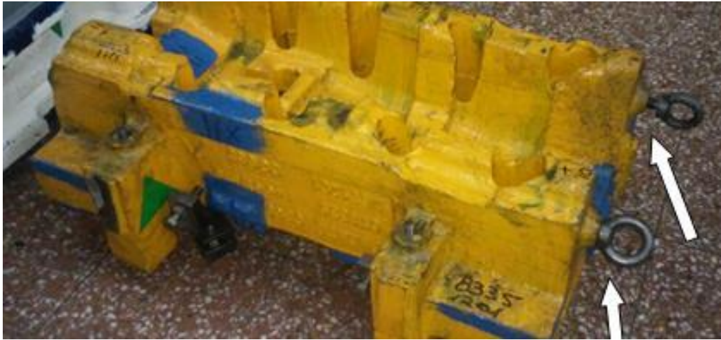
Figura 57. Bujes roscados para colocar cáncamos para movimiento.
