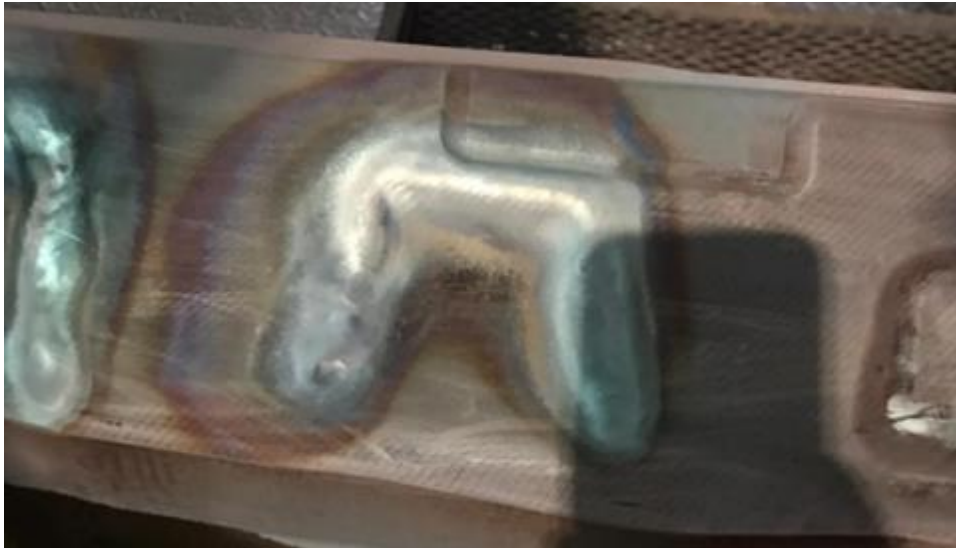
Figura 72. Prueba de temple a la llama, pero sin aire forzado.
