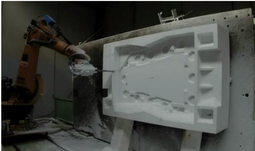
Figura 12. Robot Mecanizando el bloque de "Telgopor" para obtener el modelo.
