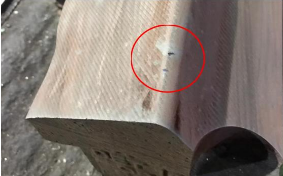
Figura 70. Marcas de lima realizadas para corroborar la dureza.
