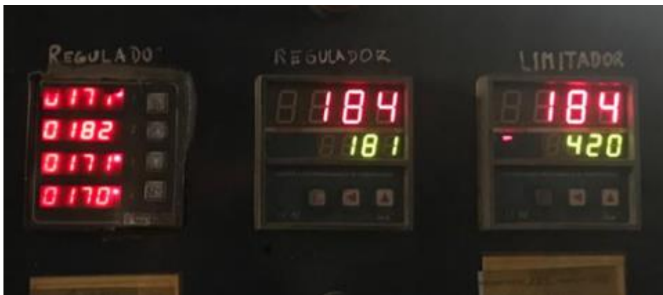
Figura 76. Controlador del horno para el proceso de revenido.
