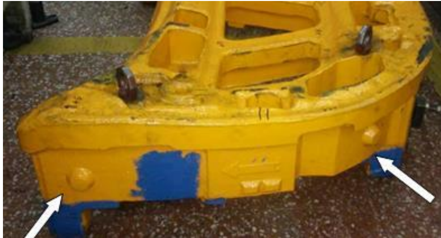
Figura 59. Bujes para cáncamos para girar el detalle.
