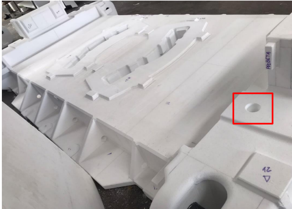
Figura 63. Modelo de base con pasaje de columna mecanizado.
