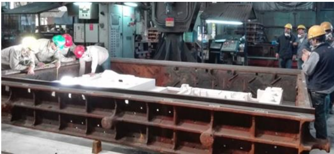
Figura 18. Caja de moldeo colocada alrededor del modelo
