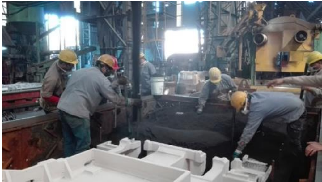
Figura 19. Bombeado de arena y llenado del molde
