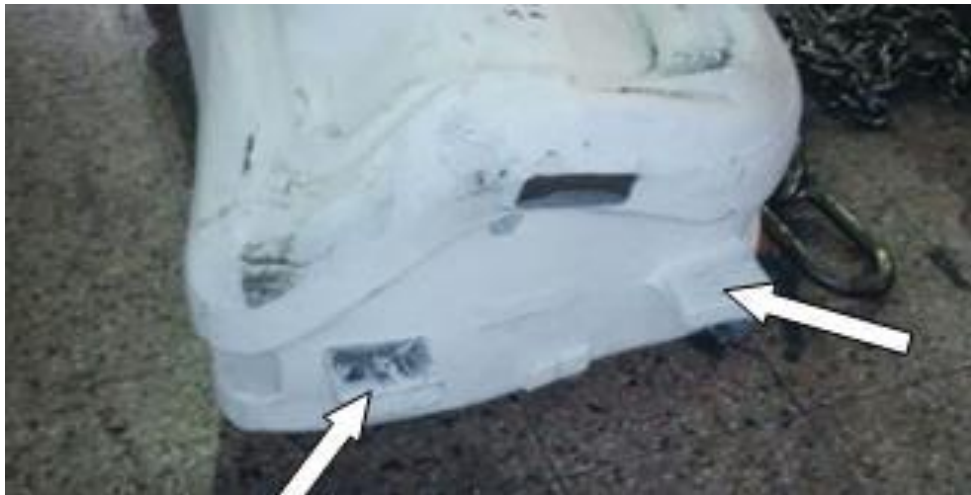
Figura 58. Tacos niveladores para mecanizar.
