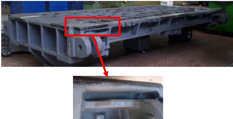
Figura 41. Base con zona de difícil acceso, mal moldeada y en donde aparece arena sinterizada.
