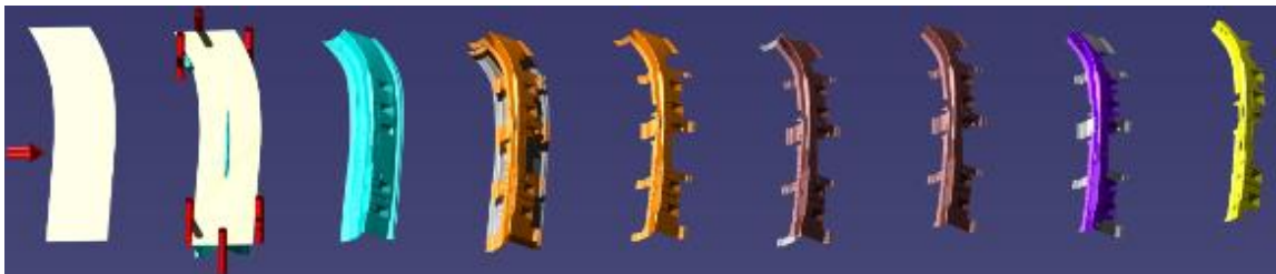
Figura 4. Proceso de estampado de una pieza de chapa.
