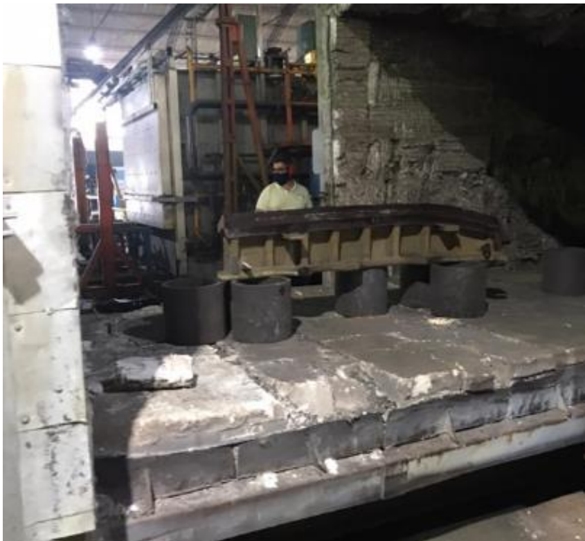
Figura 69. Detalle fundido listo para templar luego del precalentamiento.
