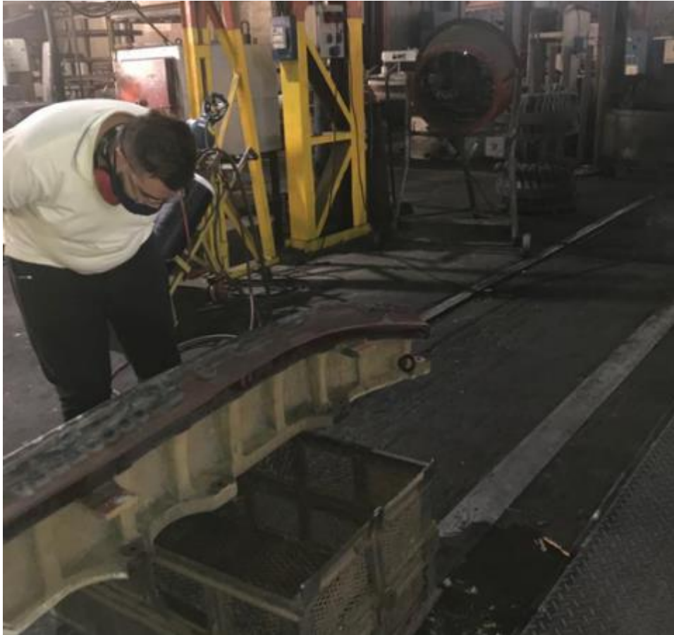
Figura 75. Enfriamiento del punzón con un ventilador.
