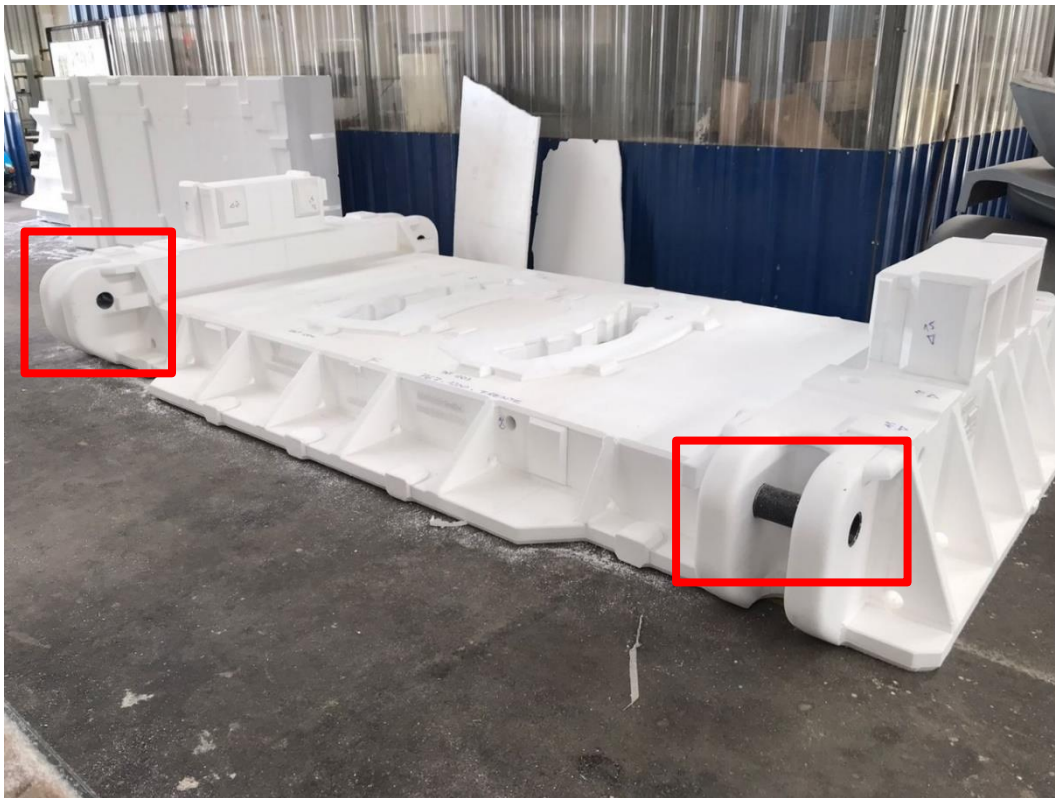
Figura 61. Modelo de Base superior con agujeros alineados para conservar concentricidad.
