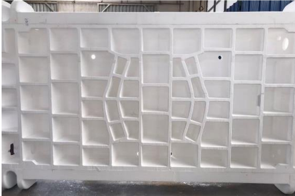
Figura 62. Modelo de Base con entrecruzamiento de nervios optimizado.
