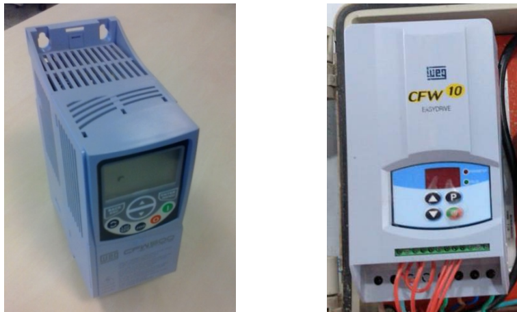
Figura 3. Otros dos de los componentes principales: (a) variador de frecuencia moderno con funciones de PLC incorporadas, y (b) variador de frecuencia tradicional.
