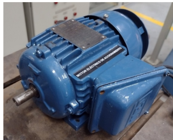
Figura 2. Dos de los componentes principales: (a) máquina eléctrica didáctica trifásica de inducción con rotor bobinado, y (b) motor asincrónico trifásico estándar.
